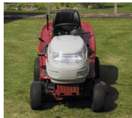
Die Räder überragen das laut Hersteller 105 cm breite Mähwerk. Durch das zweimalige Überfahren des Rasens bleiben am Ende oftmals dunkle, vom niedergedrückten Gras her rührende Streifen zurück.
