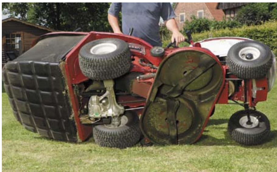
Am Mähdeck gibt es nur hinten Tasträder (heute verstärkt), stattdessen „schwimmt“ es auf dem Gras wodurch eine gute Konturanpassung erzielt werden soll. Bei uns führte diese Technik bei hohem Gras zu einem schiefem Schnittbild.
