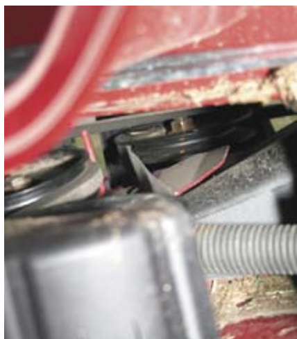
Der Hauptriemen läuft kreuz und quer und ist in sich sogar mehrmals verdreht – das kann auf Kosten der Haltbarkeit gehen.
