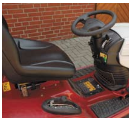
Das Fahrpedal ist sehr steil angestellt und gewöhnungsbedürftig. Zum Einstellen der Schnitthöhe befindet sich rechts vom Sitz ein Hebel mit sechs Rasten.
