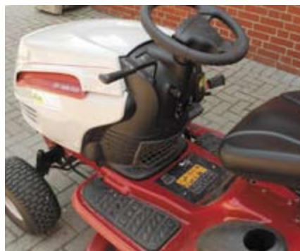
Das Mähwerk wird mit dem Hebel links vom Lenkrad eingeschaltet. Gut wäre, wenn man den Sitz weiter nach hinten schieben könnte.
