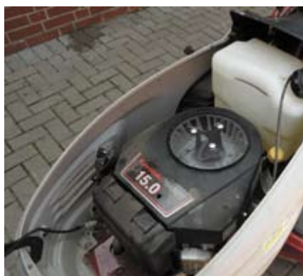
Zum Tanken des leicht kontrollierbaren Kraftstofftanks ist ein Kanister mit „Rüssel“ erforderlich. Die Leistung des Kawasaki-Motors ist mit 15 PS angegeben.
