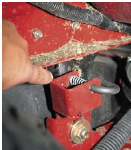
Bei der Testmaschine hängte sich immer wieder das Mähdeck aus.
