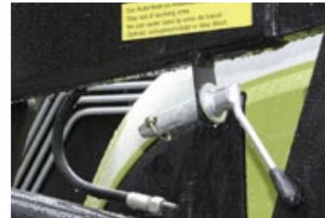
Beim Einfahren ist aufgrund der engen Schwinne mit breiten Motorhauben Vorsicht geboten (auf Wunsch sind breite Schwingen lieferbar). Beim Frontladeranbau werden die Konsolen mit losen Bolzen verriegelt, deren Sicherung mit einem Klappstecker umständlich ist. Vorteil: Die Schwinne passt auch an eine ältere Baas-Konsole.
