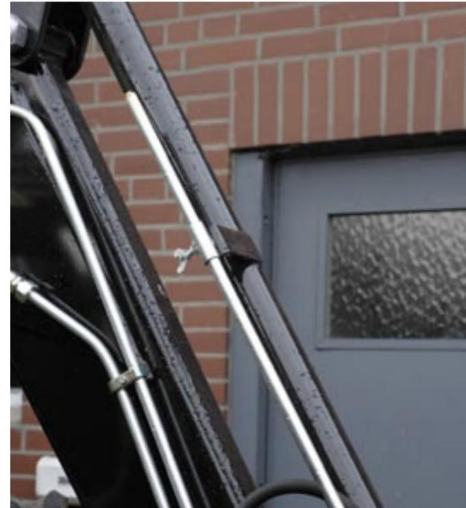
Die Neigungsanzeige ist dank der Flügelschraube ohne Werkzeug verstellbar.
