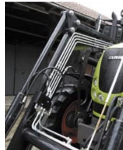
Die Hydraulikventile und -leitungen sind nicht gerade förderlich für eine gute Sicht vor dem zweiten Querholm angebracht.
