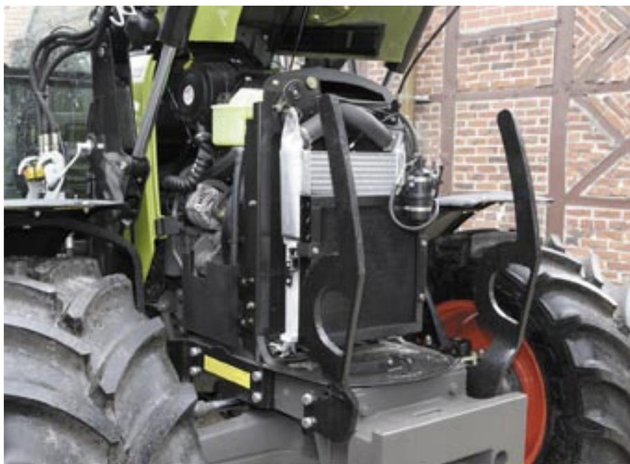
Alle Wartungsstellen am Claas Ares 557 waren bei angebauter Schwinde gut erreichbar. Der Luftfilter lässt sich bei mittelhoher Schwinde ausbauen.
