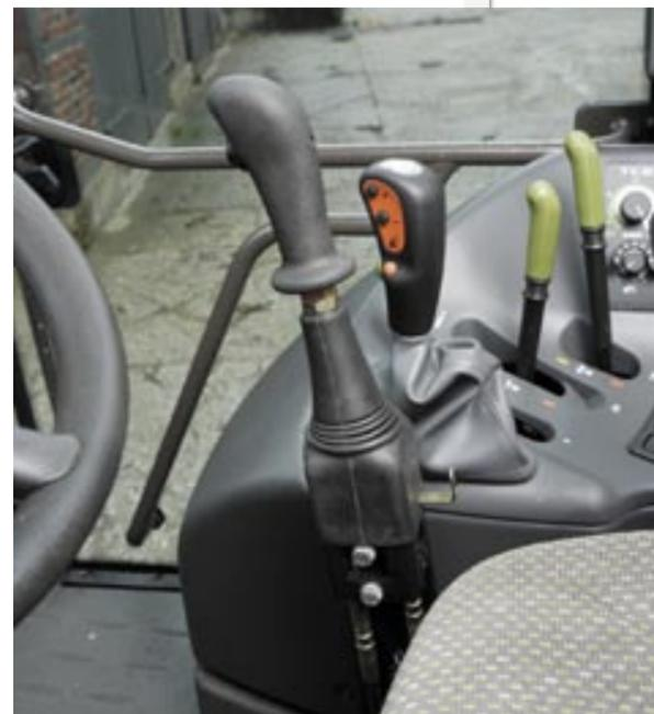
Griffgünstig vor der rechten Armlehne ist der in der Neigung verstellbare Joystick mit einem Taster auf der Vorderseite für den dritten Ölkreis montiert. Alle Funktionen sind gut mischbar, die Wege des Hebels könnten allerdings etwas kürzer sein, auch um nicht mit dem Lenkrad zu kollidieren.
