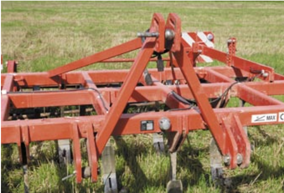
Der Anbaubock des RKLx ist geschweißt und bietet in der Kat. III N eine Koppelhöhe. Für den Oberlenker gibt es drei Bohrungen, die oberste davon ist als Langloch ausgeführt. Praktisch ist die Steckverbindung der Lichtanlage zum Schlepper.
