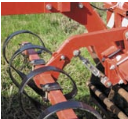
Trotz Verschleißplatte an den Zustreichern und vielfältiger Verstellmöglichkeiten (leider immer mit Werkzeug) hat uns die Arbeit der Zustreicher nicht immer zufriedengestellt.
