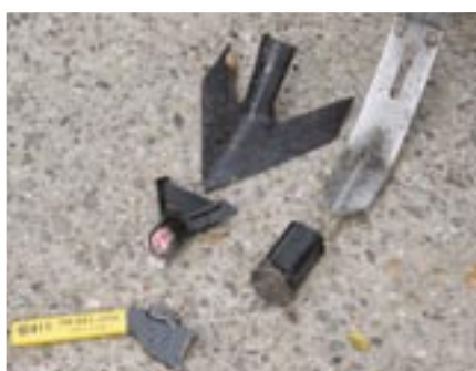
Mit dem Schnellwechselsystem ist die Scharauswahl für den SMS reichlich bemessen. Der Scharwechsel klappt gut, wenn das Werkzeug zur Hand ist.
