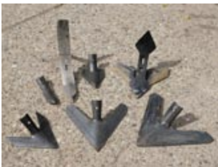
Mit dem Schnellwechselsystem ist die Scharauswahl für den SMS reichlich bemessen. Der Scharwechsel klappt gut, wenn das Werkzeug zur Hand ist.
