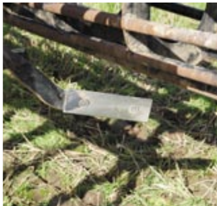
Trotz Verschleißplatte an den Zustreichern und vielfältiger Verstellmöglichkeiten (leider immer mit Werkzeug) hat uns die Arbeit der Zustreicher nicht immer zufriedengestellt.
