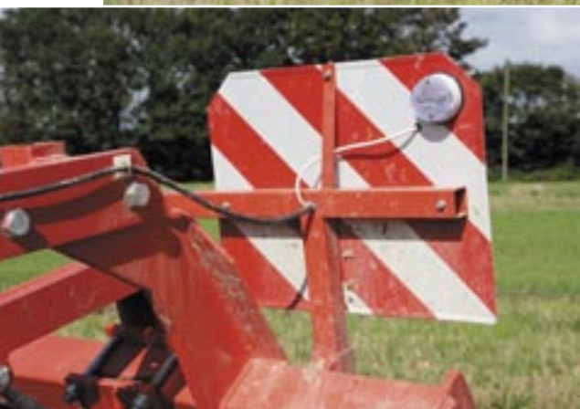
Leider ohne Stecker zum Trennen des Kabels: die gut gemeinte abnehmbare Beleuchtung des RKLx für einen Aufpreis von 180 Euro.
