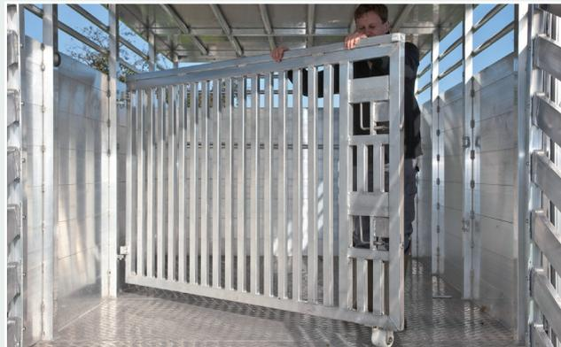
*Der Laderaum ist zwar nur in einer Position trennbar, aber das große Tor mit Stützrolle und sicherer Parkhalterung konnte überzeugen. So können auch Kälber ohne Unterschlupfmöglichkeit sicher von den Kühen getrennt werden.*
