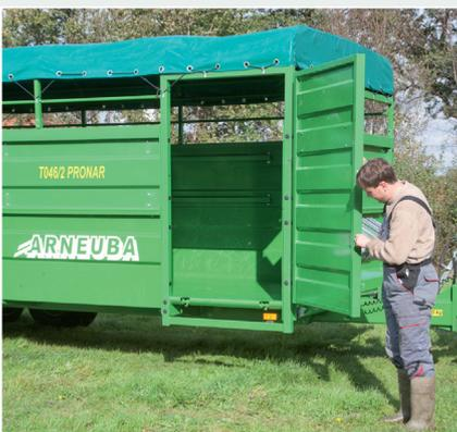
*Die vordere Tür kann sowohl seitlich geschwenkt als auch als Rampe geöffnet werden. Aber als Auflauframpe für Kälber ist die Klappe viel zu glatt und darf zudem nur mit 150 kg belastet werden.*
