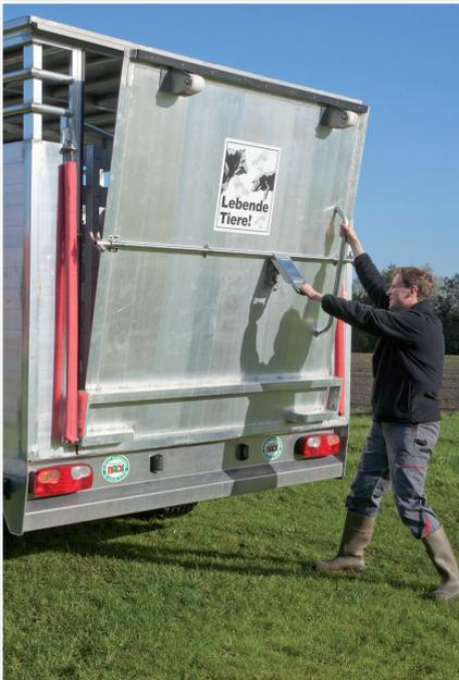
*Die Klappe mit Kunststoffrollen lässt sich dank Griff einfach öffnen. Nur die Federn des Hebels für den Schließmechanismus lösten sich.*
