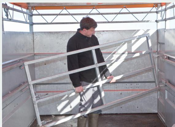
Die Verstellung des Gatters in dem Wagen ist nicht ganz einfach, insbesondere das Einhaken. Die federbelasteten Bolzen mit Führung zum Einrasten sind gut.
