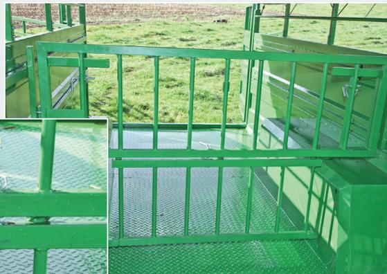
*Das Trenngatter lässt sich nur mit Werkzeug in der Position verändern. Die Radkästen sind aufgrund der Tandemachse im Vergleich am größten. Der untere Teil des Gatters wird nur durch einen kleinen Bolzen gesichert.*
