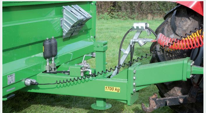
*Die Deichsel kann für eine Untenanhängung umgeschraubt werden. Zwei absperzbare Gasdruckdämpfer dämpfen Stöße auf der Straße ab. Der Stützfuß ist leider nicht über eine Lochleiste verstellbar.*
