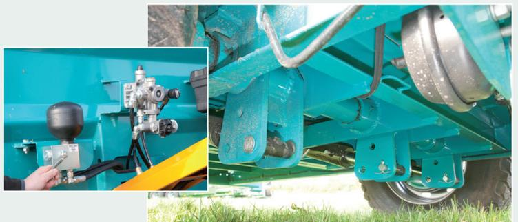
*Drei Zylinder ohne Sperrblock drücken den Wagen hoch in die Transportposition. Per Absperrrahn wird ein ungewolltes Absenken verhindert.*
