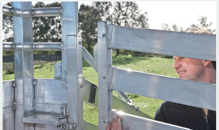
*Die Federn tragen einen Teil der Gatter – sehr gut! Da die Tore breiter sind als die Klappenöffnungen, können sie einfach und sicher hinter die Pfosten gehoben werden.*
