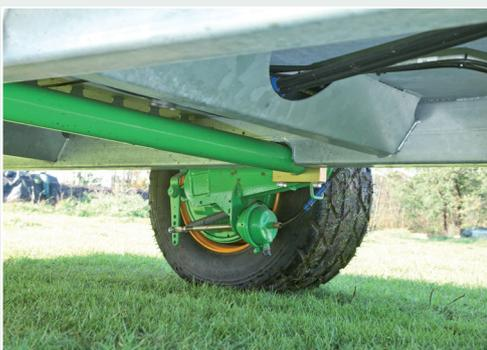
Die Bodenfreiheit wird durch die Bremszylinder eingeschränkt.
