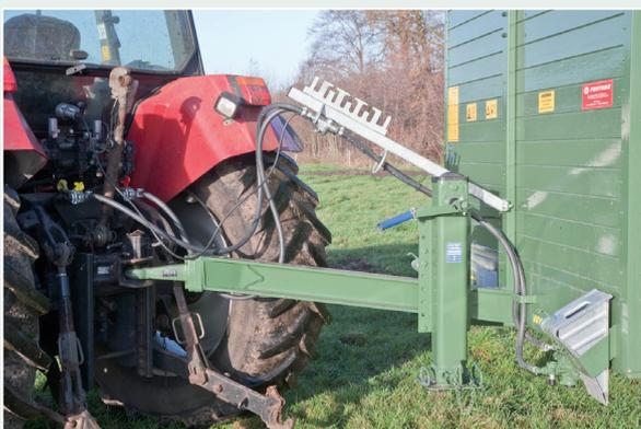
*Die Anhängung: Die schmale Deichsel, die Schlauchgarde sowie der Galgen und Stützfuß überzeugen.*
