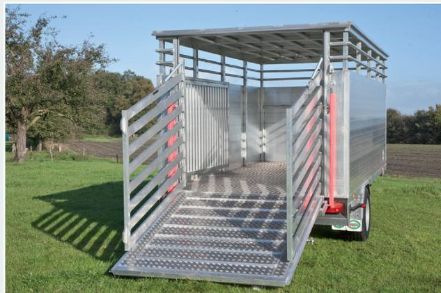
*Der Wagen lässt sich ohne Staukanten und dank glatter Oberflächen sehr gut reinigen. Eine Querstange an der Frontwand dient als Strickhalter.*
