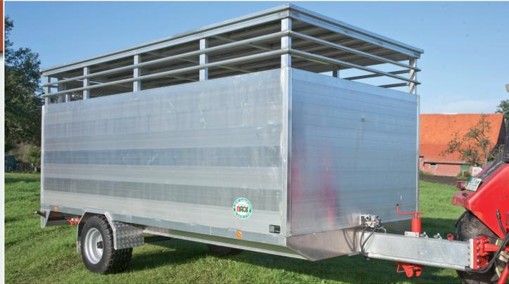
*Ergebnis der konsequenten Aluminium-Bauweise: nur 1 550 kg Leergewicht. Selbst der Rahmen ist aus dem Leichtmetall gefertigt.*
