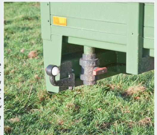
*Die Kunststoffhähne im Heck des Wagens sind werkzeuglos zu öffnen. Leider dichtet die Heckklappe nicht ab, so dass Jauche auf öffentlichen Wegen unkontrolliert auslaufen kann.*
