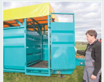
*Der Radkasten verhindert eine Abtrennung im hinteren Teil des Wagens. Für eine mögliche Behandlung können mit Hilfe der Trennwand und der seitlichen Tür Tiere gut vereinzelt werden.*
