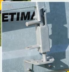
Zum Ausfahren der Treibgatter muss man über 40 kg stemmen. Gleichzeitig muss das Gatter gedreht werden, sonst kollidiert das hintere Ende mit den Kotflügeln des Wagens. Die Bolzen der ausgefahrenen Gatter verbiegen bei angehobenem Wagen.
