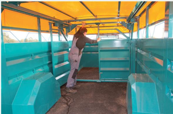
*Als Einziges im Test hatte das Modell ein verschiebbares Gatter mit zwei Flügeltüren installiert. So lässt sich der Laderaum komfortabel trennen. Nachteil: der Geräuschpegel während der Fahrt und die aufwändigere Reinigung.*
