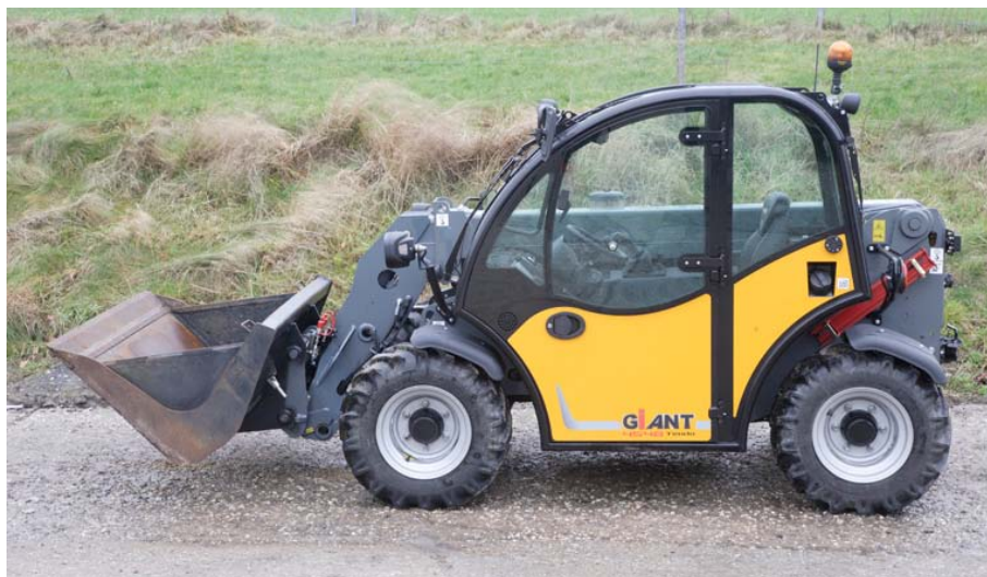
Der Giant 4548 Tendo ist vom Design her ein typischer Teleskoplader moderner Bauart: mit mittig zwischen Motor und Kabine angeordnetem Telearm.
