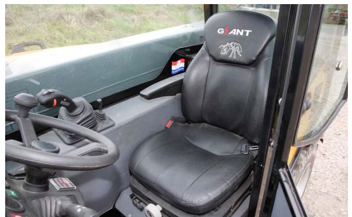
Der abwaschbare Sitz ist mechanisch gefedert. Statt der schmalen rechten Armlehne am Sitz hätten wir uns für eine ergonomischere Joystick-Bedienung eine Armauflage auf der rechten Konsole gewünscht.
