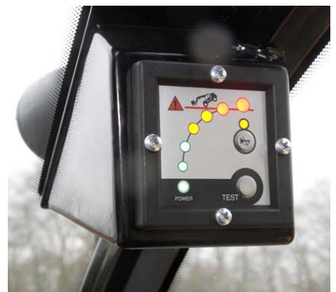
Oben rechts in der Kabine ist die Lastanzeige recht übersichtlich angeordnet.
