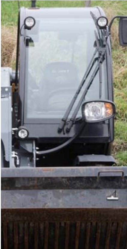
Der doppelte Scheibenwischer bietet ein großes Wischfeld.
