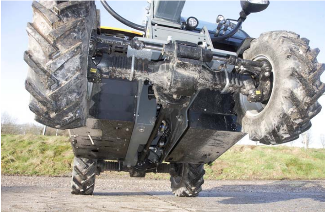
Kardanwelle und weitere Komponenten sind von unten nicht durch eine Bodenplatte geschützt.
