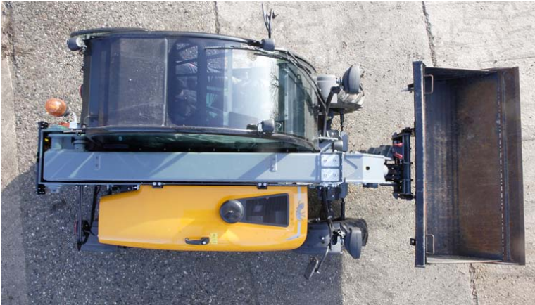
Dank gewölbter Scheibe hat man eine gute Sicht auf das Werkzeug. Das Schutzgitter befindet sich leider unterhalb der Scheibe.
