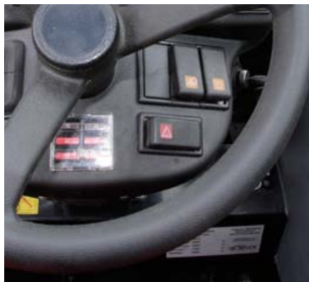
Sicherungen finden sich sowohl in der Kabine als auch im Motorraum.
