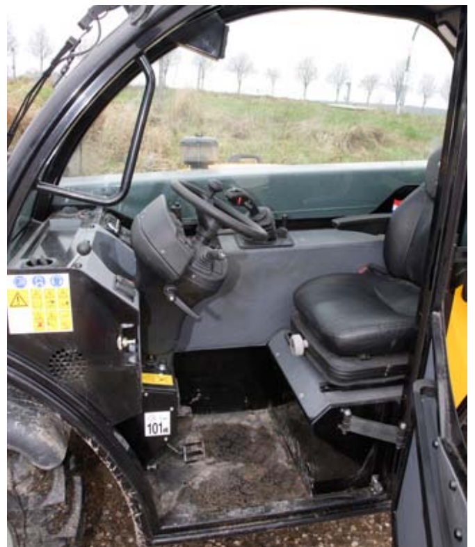
Dank weit öffnender Tür, ordentlichem Haltegriff und niedriger Stufe gelangt man recht bequem in die Kabine.
