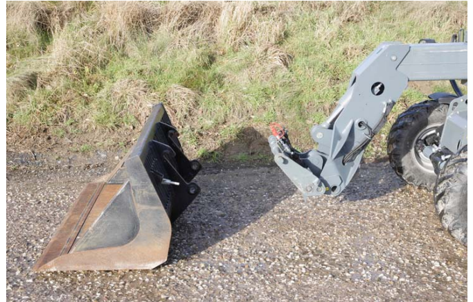
Der Schnellwechselrahmen stammt von den knickgelenkten Hofladern und ist prima zu handhaben. Die hydraulische Verriegelung des Werkzeugs lässt sich gut einsehen.
