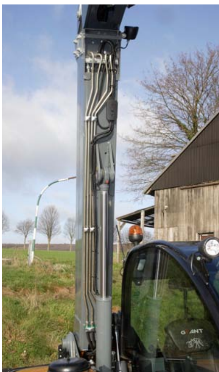
Die Leitungen sind unter und im Teleskoparm sauber verlegt.
