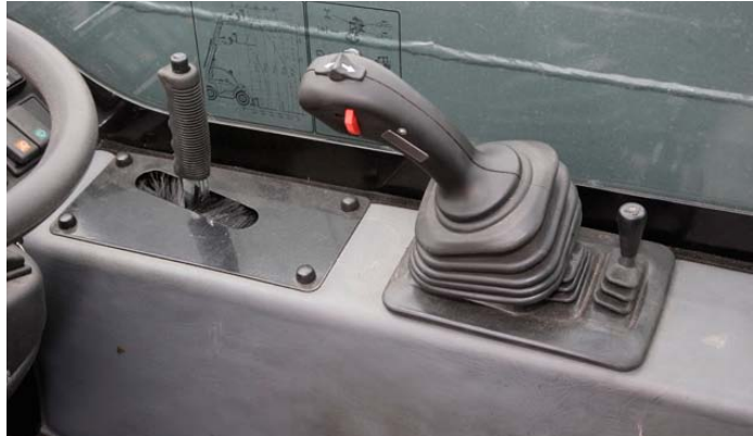
Die Handbremse mit konventionellem Rastenhebel ist auf der rechten Seite vor dem Joystick platziert.
