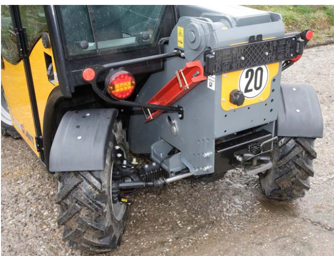
Zur Serie will Giant andere Achsen einbauen. Dann sollen auch die in Bohrungen versteckten Schmiernippel der Achsschenkel besser erreichbar sein.
