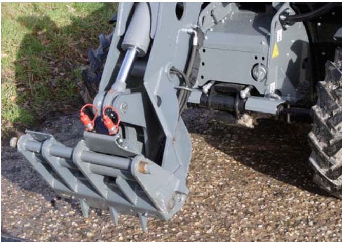
Die beiden Ölkupplungen für die vierte Hydraulikfunktion (ohne drucklosen Rücklauf) sind am Schnellwechselrahmen montiert – prima. Noch stehen sie allerdings recht weit nach oben hinaus, das will Giant ändern.
