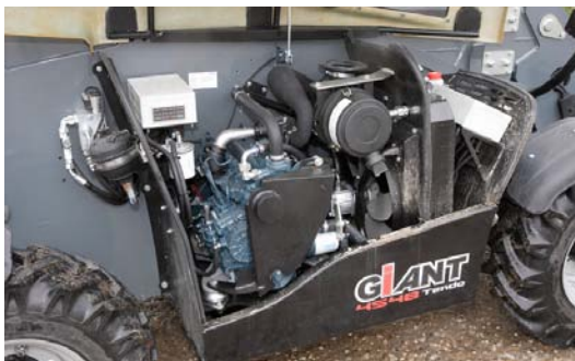
Für den Turbomotor mit vier Zylindern von Kubota gibt Giant eine Leistung von 33 kW/45 PS an.
