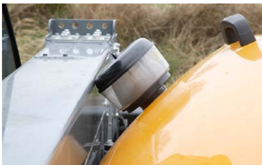
Beim Öffnen der Motorhaube stößt der Vorabscheider gegen den abgesenkten Arm. Zum vollständigen Öffnen der Haube muss man den Arm anheben. Ein Sensor sperrt dann die Arbeitshydraulik, damit die Haube nicht beschädigt wird.
