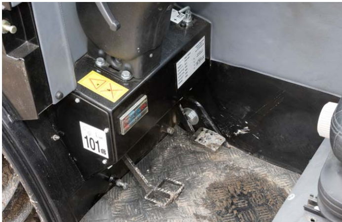
Das an sich gute, griffige Inch-/Bremspedal steht für eine bequeme Fußstellung leider zu hoch.
