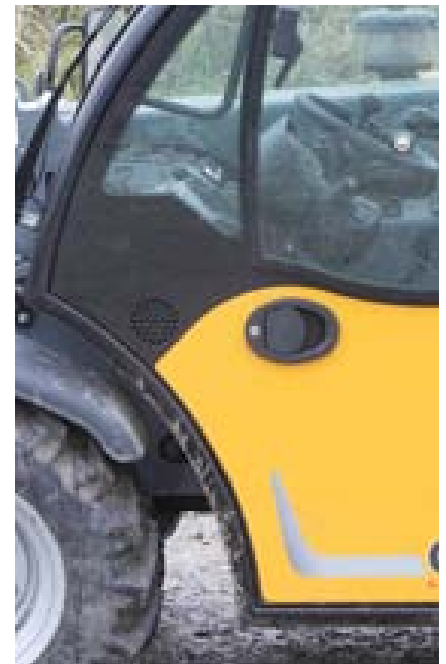
Durch die Luftansaugöffnung des Frischluftgebläses konnte bei unserem Testkandidat noch Wasser eindringen. Das will Giant in Zukunft besser abdichten.
