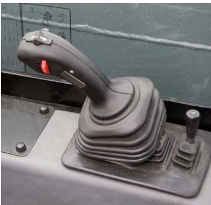
Oben auf dem Joystick sitzt die Wendeschaltung. Mit dem roten Kippschalter links am Hebel lässt sich die Fahrstufen-Automatik manuell schalten. Zwei Taster vorne auf dem Joystick sind für die Teleskopfunktion vorgesehen, und mit dem oberen Taster auf der rechten Seite wird im Allradmodus auf Hundeganglenkung umgestellt. Für die vierte Funktion ist ein zusätzlicher Hebel zu bedienen (auf Wunsch per Taster).
