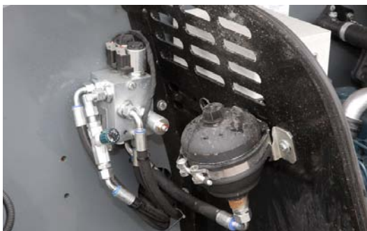
Die Stickstoffblase samt Elektroventil gehört zur Schwingungstilgung des Telearms.
