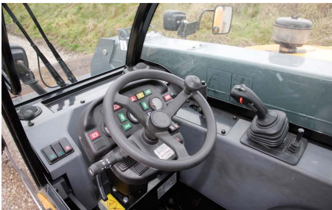
Die Lenksäule samt Instrumentenkonsolle ist in Neigung und Höhe einstellbar.
