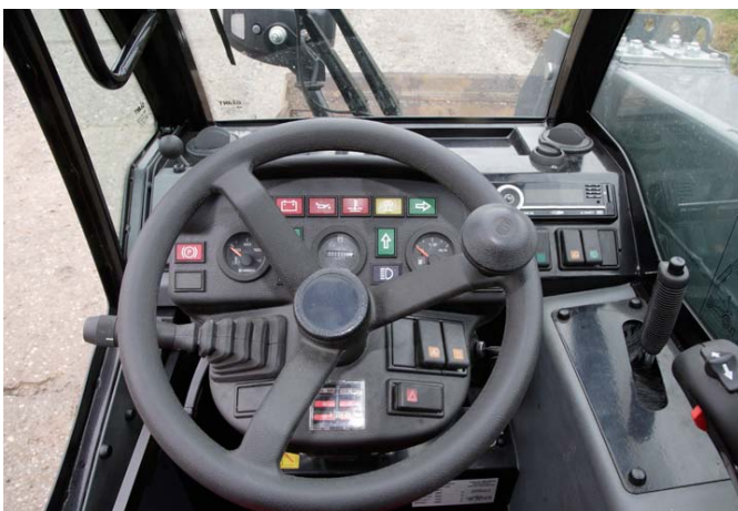
Noch sind die einzelnen Schalter, die leider erst bei Funktion unterleuchtet und noch nicht eindeutig gekennzeichnet sind, etwas verstreut angeordnet (das will Giant ändern).
