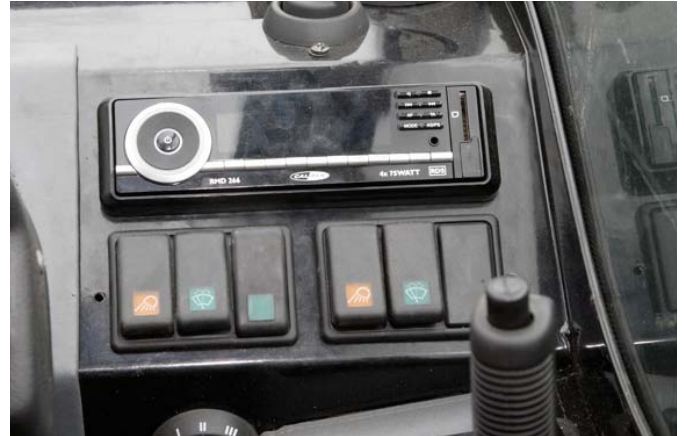
Per Kippschalter (dritter von links) kann zwischen Vorderrad- und Allradlenkung umgeschaltet werden.
