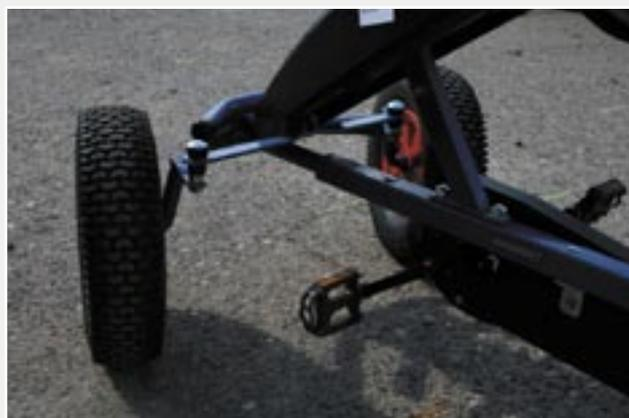
Der Freilauf schaltet automatisch. Die Spurstangen haben zusätzliche Kunststoffbuchsen.
