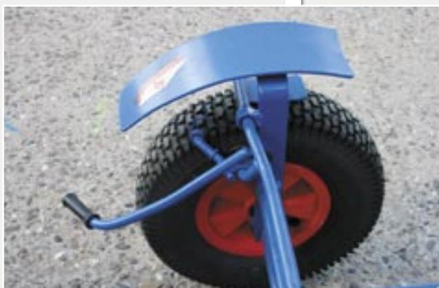
Die Handbremse hat eigentlich eine einfache Feststellfunktion. Diese hat im Test aber nicht durchgehalten.
