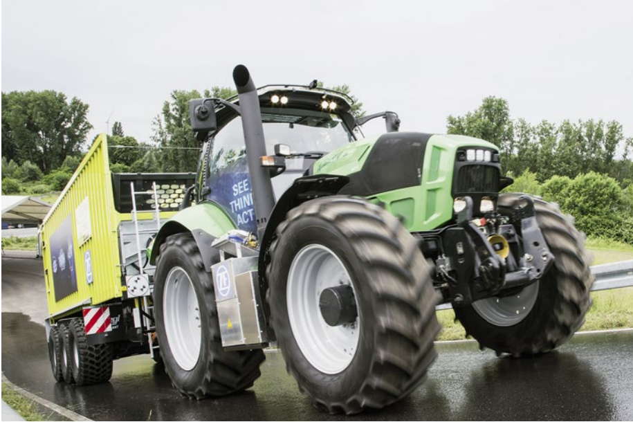
Der „Innovation Tractor“ von ZF kann ganz von allein an einen Anhänger rangieren und ankuppeln. Foto: ZF
