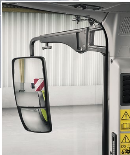
Mehr Sicherheit im Straßenverkehr: Weitwinkelrückspiegel mit zwei getrennt einstellbaren Sichtfeldern am Claas Axion.
