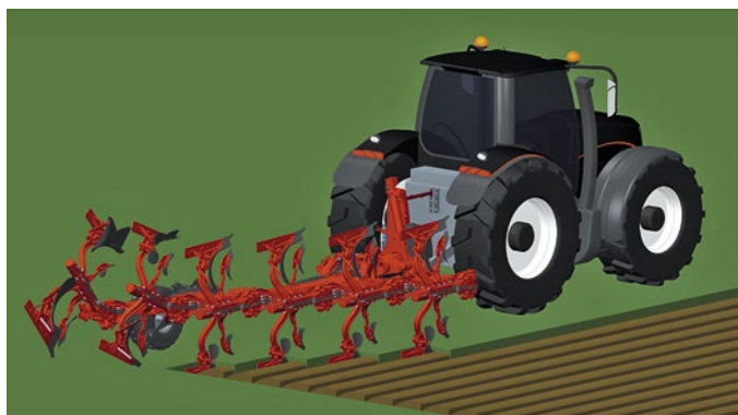
Bei „Section control“ von Kuhn werden die Pflugkörper GPS-gesteuert automatisch einzeln ausgehoben und wieder eingesetzt. Grafik: Kuhn
