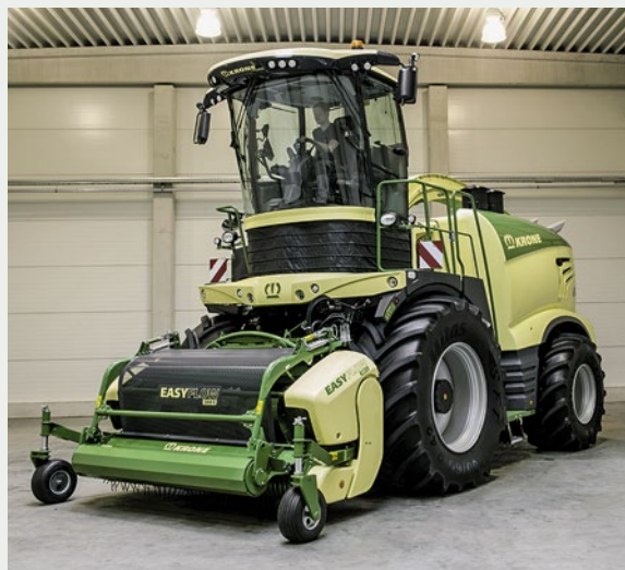
Bei der Krone LiftCab wird die Kabine auf Knopfdruck um 70 cm angehoben.
