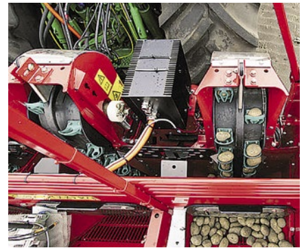
Die Legeelemente von Kartoffellegemaschinen können in Zukunft elektrisch angetrieben werden. Foto: Grimme
