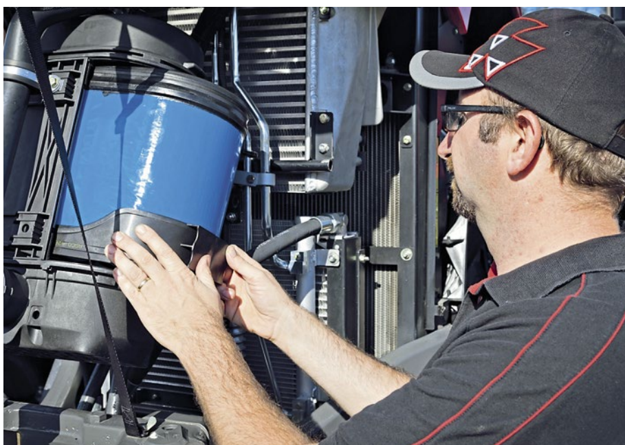
Neben den gängigen walzenförmigen Luftfiltern sind viele Schlepper mit individuell ausgeführten Filtern ausgestattet. Fotos: Hersteller, Theißen (2)
