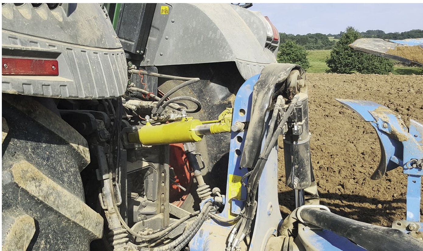
Der Anbauraum zwischen Schlepper und Gerät ist oft eng. Verschiedene Kuppelhilfen erleichtern den Anbau.
