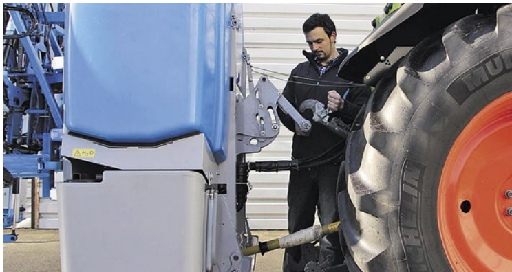
Traktorenhersteller und Spezialisten wie Walterscheid suchen stets nach Lösungen für den einfachen Geräteanbau. Aber auch die Gerätehersteller entwickeln innovative Kuppelhilfen – wie hier das System „Quick Connect“ von Lemken.
