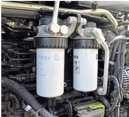
Kraftstofffilter sollen neben Schmutzpartikeln auch Wasser vom Diesel abscheiden.
