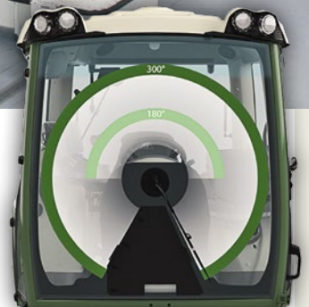
Statt nur einen Halbkreis von 180° wischt der Scheibenwischer von Fendt einen Bereich von 300°.
