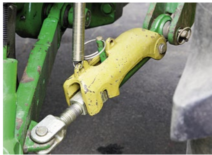
Automatische Unterlenkerstabilisierung: Das Spreizmaß der Unterlenker wird federnd auf dem eingestellten Abstand gehalten und erleichtert so das Ankuppeln mit Fanghaken.
