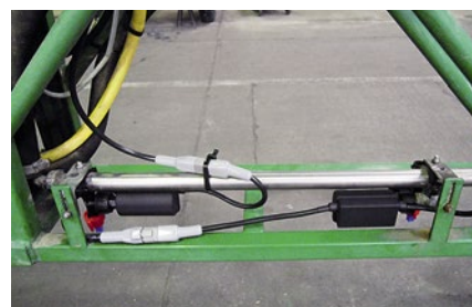
Nach jeder Inbetriebnahme des Feldspritzgerätes erfolgt eine automatische Konfiguration der ESV-Ventile über den CAN-Bus.
