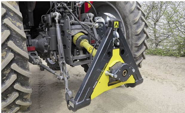
Traktorenhersteller und Spezialisten wie Walterscheid suchen stets nach Lösungen für den einfachen Geräteanbau. Aber auch die Gerätehersteller entwickeln innovative Kuppelhilfen – wie hier das System „Quick Connect“ von Lemken.
