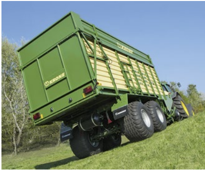
Das Achsaggregat hat großen Einfluss auf die Wankstabilität des Silierwagens. Foto: Krone
