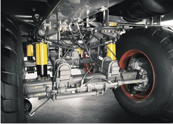
Hydraulisch gefederte Fahrwerke gleichen Bodenunebenheiten aus. Foto: Claas
