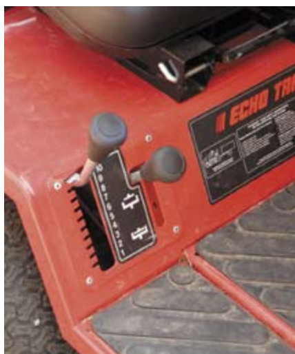
Die Schnitthöhe lässt sich nur im Bereich von 4,3 cm verstellen und man muss jedes Mal die richtige Raste wiedersuchen. Daneben der Hebel zum Kuppeln der Kehrwalze.
