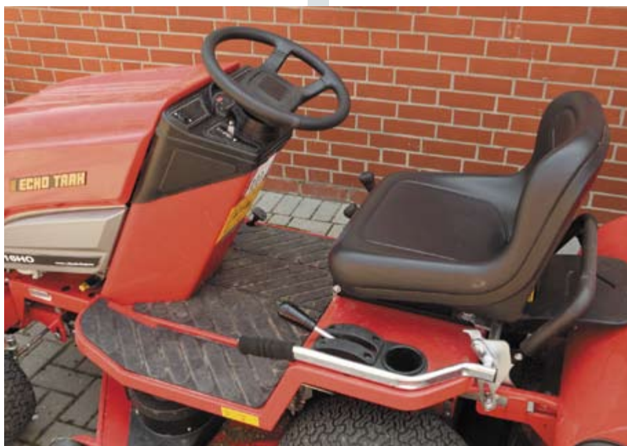
Der kleine Hebel ist die Parkbremse, der große zum Ausheben der Sammelinheit, was bei vollem Korb schwer geht. Der Sitz ist bequem, geht aber nicht weit genug zurück.
