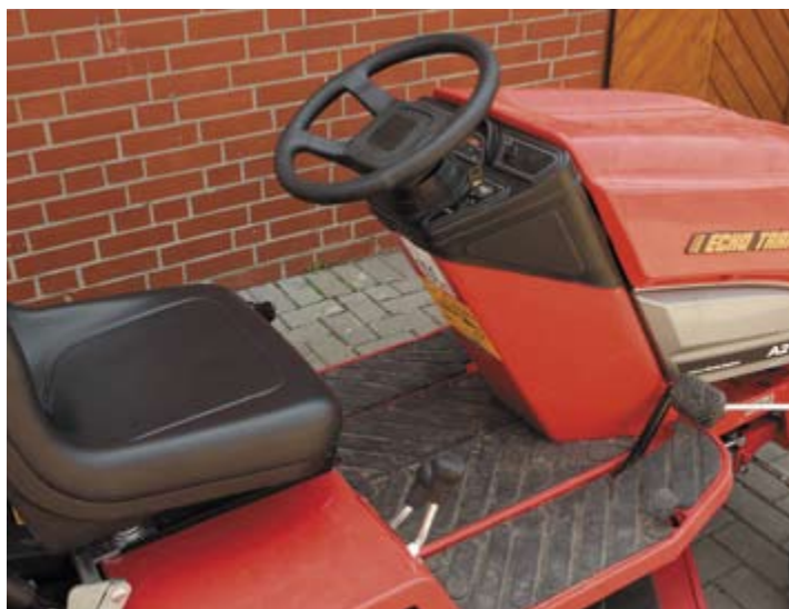
Die Fahrpedale sitzen ergonomisch günstig, es gibt aber keine Fußbremse. Die doppelwandige Motorhaube sorgt für nur 87 dB(A).
