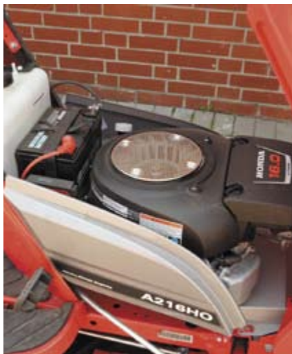
Der Honda-Motor GXV 520 ist zwar „nur“ mit 12 kW/16 PS angegeben und entsprechend sparsam, kommt aber mit dem Echo gut zurecht. Der Tank hat einen Reservemelder, sollte aber ruhig etwas größer als 7,5 l sein.
