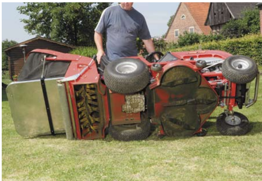
Das Drei-Messer-Mähwerk ist unempfindlich gegenüber Fremdkörpern. Das Mähgut wird am Boden abgelegt und von der Kehrwalze wieder aufgenommen.
