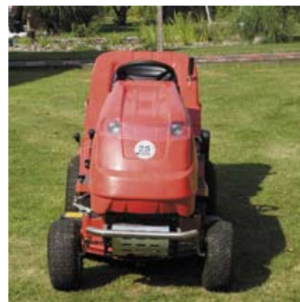
Das Design ist Geschmackssache, aber es gibt eine Stoßstange aus Edelstahl und eine solide doppelwandige Haube. Die Lenkung ist sehr direkt und präzise, der Wendekreis durchschnittlich.
