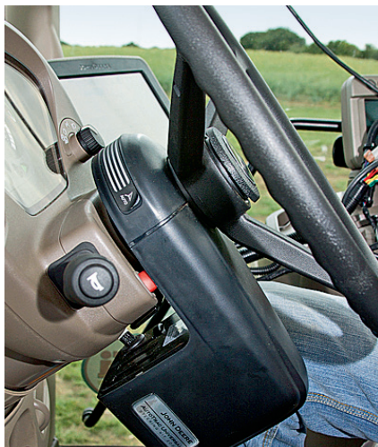
Der Motor des AutoTrac Universal befindet sich unter der Lenksäule, kann aber auch in anderer Stellung montiert werden.
