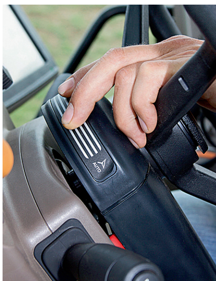
Die Automatiklenkung wird über diese Berührungsfläche aktiviert, die oben um die Lenkeinheit läuft. Optional gibt es auch einen externen Schalter. Andere Hersteller realisieren diese Funktion über den berührungsempfindlichen Bildschirm, was besser ist.
