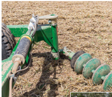
Das hydraulische Verdrehen der Aufhängung stellt die Kettenspannung ein.
