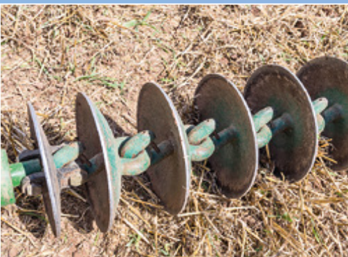
Die einzelnen Scheibenelemente aus Vollguss sind über ein Haken-Öse-System verbunden.
