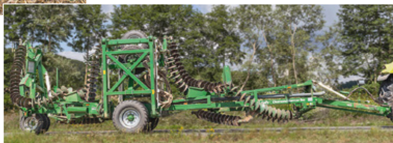
Zum Transport wird die Kelly auf 2,40 m Breite geklappt.
