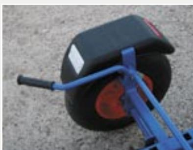
Die einfache Handbremse wirkt auf beide Räder und lässt sich mit der zweiten Hand feststellen.
