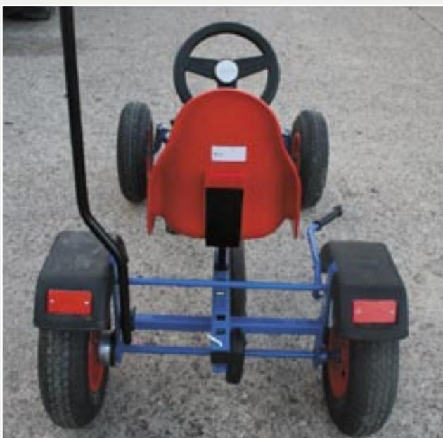
Die Sitzverstellung in Löchern geht immer noch am einfachsten. Der Bolzen der Anhängerkupplung ist federbelastet, damit er nicht verloren geht.
