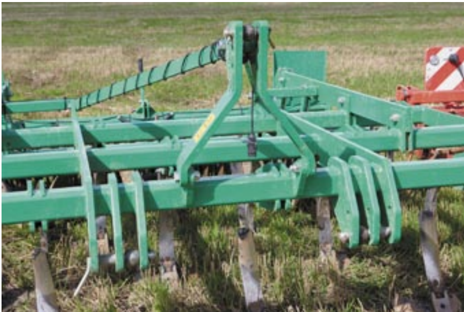
Der Anbaubock des Mulchmaster bietet zwei Koppelhöhen und getrennte Anbau-räume für Kat. II und III. Die Kabelführung ist schlicht, aber zweckmäßig.
