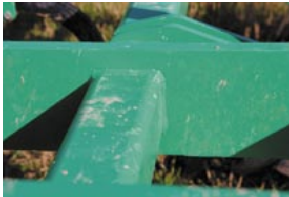
Die 100 x 100 mm Quadratrohre sind durch die aufrechten Flach-eisen des Rahmens hindurchgeführt und anschließend ver-schweißt. Diese Lösung bietet laut Daweke mehr Stabilität.
