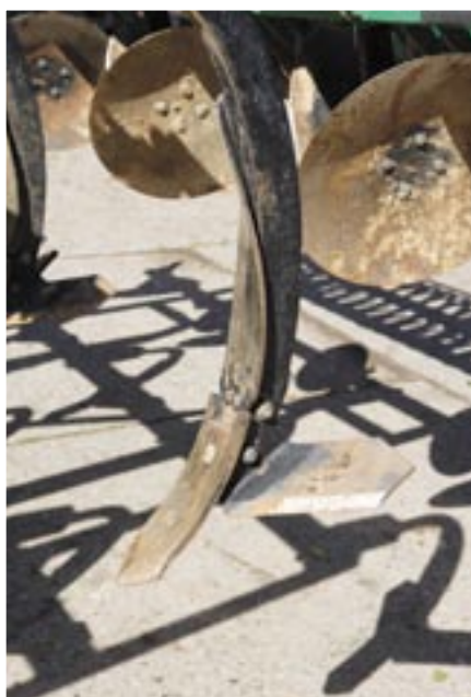
Das angeschrägte 8-cm-Schmalschar bietet Daweke zur tiefen Bearbeitung an. Will man flach arbeiten, werden zwei Flügel mit zwei Schrauben am Zinken montiert.
