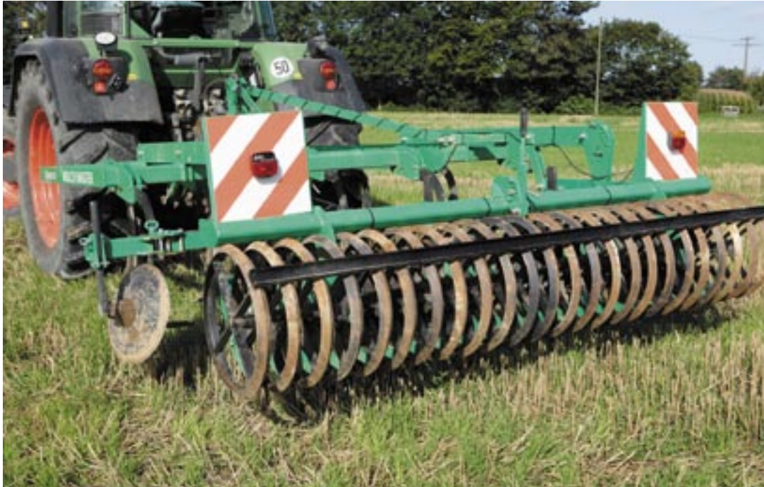
Hohlscheiben und Nachläufer gehören zur Serienausstattung und liefern gute Arbeit ab. Für einen Minderpreis von knapp 700 Euro kann eine 52-cm-Stabwalze geordert werden.
