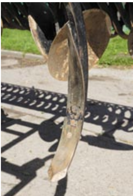
Das angeschrägte 8-cm-Schmalschar bietet Daweke zur tiefen Bearbeitung an. Will man flach arbeiten, werden zwei Flügel mit zwei Schrauben am Zinken montiert.
