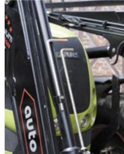
Die Neigungsanzeige für das Arbeitsgerät zeigt abhängig von der Hubhöhe und dem sich ändernden Sichtwinkel unterschiedlich an und ist nur mit Werkzeug verstellbar.
