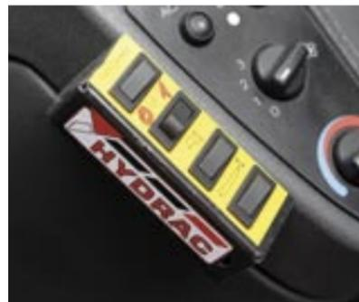
Zur Ansteuerung der Funktionen beim An- und Abbau des Laders sowie für die Zuschaltung der Schwingungstilgung und Freigabe der hydraulischen Werkzeugverriegelung gibt es eine noch nicht endgültig beschriftete Schalterkonsole links vom Lenkrad.
