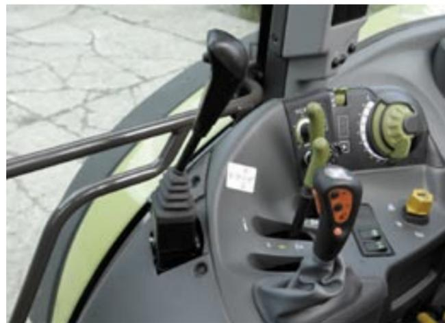
Der nicht verstellbare Joystick mit dem Taster für die dritte Funktion selbst liegt gut in der Hand, die Einbauposition vorne rechts vor dem Handgas- und Schalthebel des Claas Ares verlangt jedoch relativ lange Arme. Die Dosier- und Mischbarkeit der Arbeitsfunktionen ist gut.
