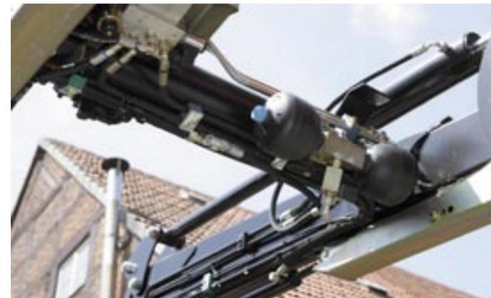
Die hydraulischen Bauteile (Elektromagnetventil, Eilgangventil, Stickstoffblasen der Schwingungstilgung) sind vergleichsweise unaufgeräumt, sichtbar und schmutzgefährdet am Querrohr angeordnet.
