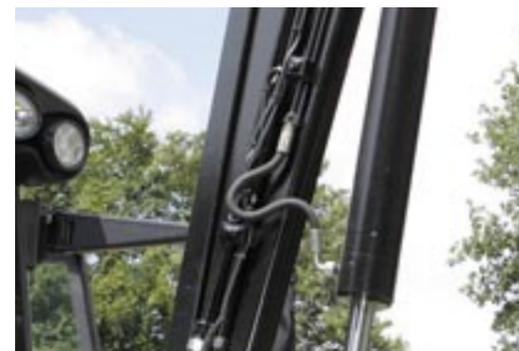
Die Ölschläuche zur Ringkammer der Hubzylinder kneifen bei maximaler Hubhöhe bedenklich.
