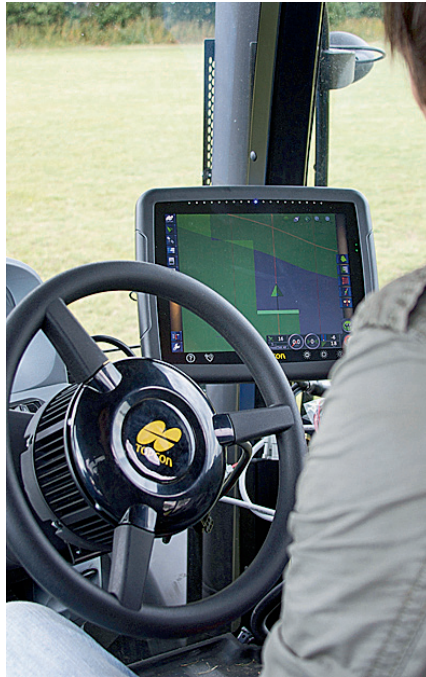
Das Lenkrad mit Motor AES-25 von Topcon und das Bedienterminal X30 nehmen nicht gerade wenig Kabinenplatz ein. Die Installation und das Umsetzen ist aber einfach.
