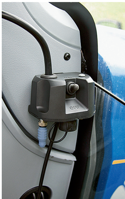
Ein Schaltkasten versorgt die Lenkeinheit mit Strom und sendet die Steuersignale. Sie kann überall in der Kabine in Reichweite des Lenkrads installiert werden.
