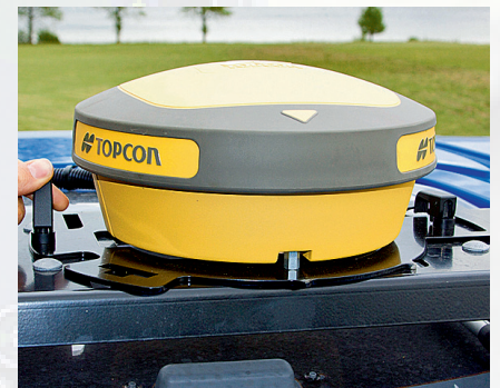
Der recht große AGI-3 Empfänger sitzt auf einer großen Dachhalterung und kann dank Schnappverschlüssen schnell umgesetzt werden.
