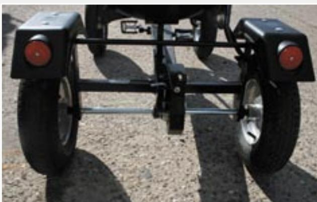
Der lose Bolzen der Anhängerkuppelung geht schnell verloren. Der Freilauf muss geschaltet werden.
