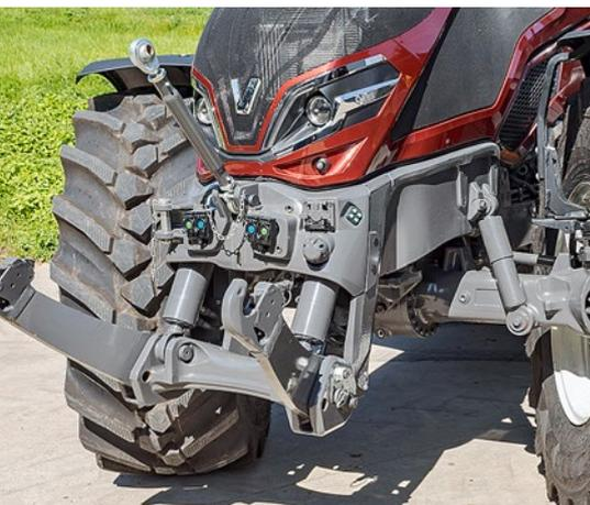
Gut integriertes Hubwerk und luftgefederte Vorderachse überzeugen.
