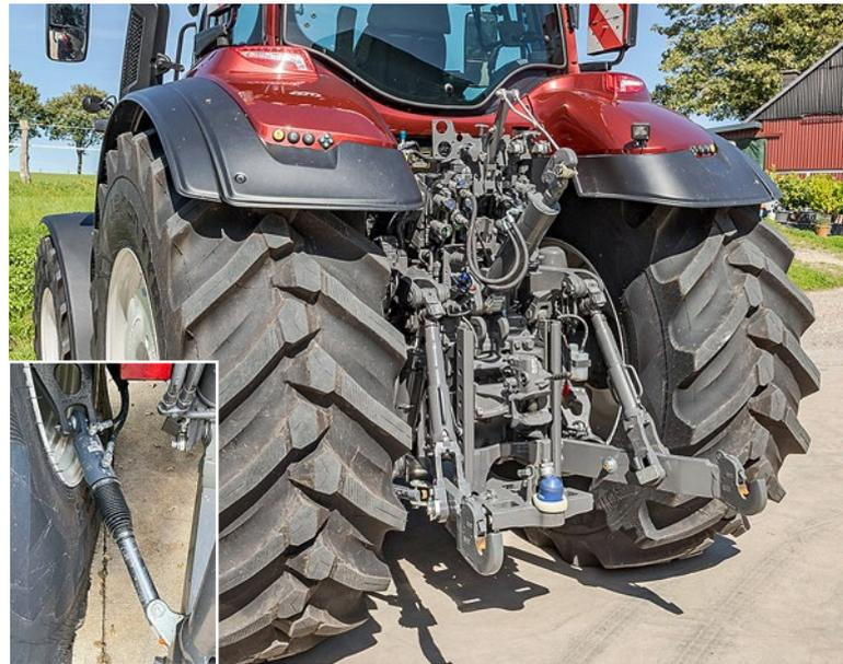
Die Hubkraft reicht immer, die hydraulischen Stabis lassen aber bei Kat. III nur ± 5 cm seitliches Spiel.
