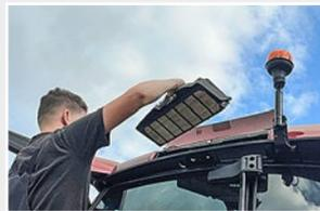
Einfach: der Ausbau des Kabinenfilters
