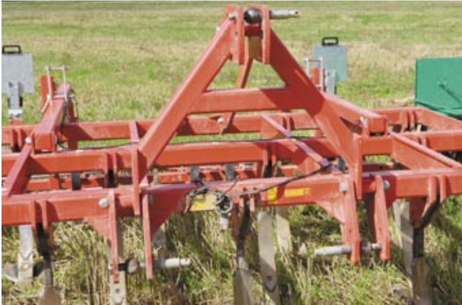
Kat. II und Kat. III können in zwei Höhen gekoppelt werden. Leider gibt es keine Trennung der Kategorien, das Bundmaß beträgt mittlere 91 cm. Die Kabelverlegung ist verbesserungswürdig.
