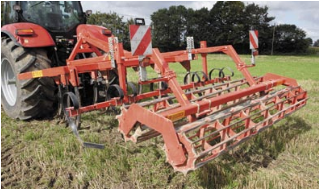
Zustreicher und Doppelwalze arbeiten gut zusammen und hinterlassen eine ebene Fläche. Auf leichten Böden arbeitet die Walze schon fast zu fein. Gegen einen Aufpreis von gut 600 Euro sind Hohlscheiben lieferbar.
