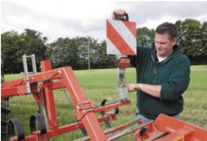
Die steckbare Geka-Beleuchtung ist unserer Meinung nach praxisfern. Erstens nimmt man sie selten ab, zweitens passt sie nicht an stark vibrierende Geräte.
