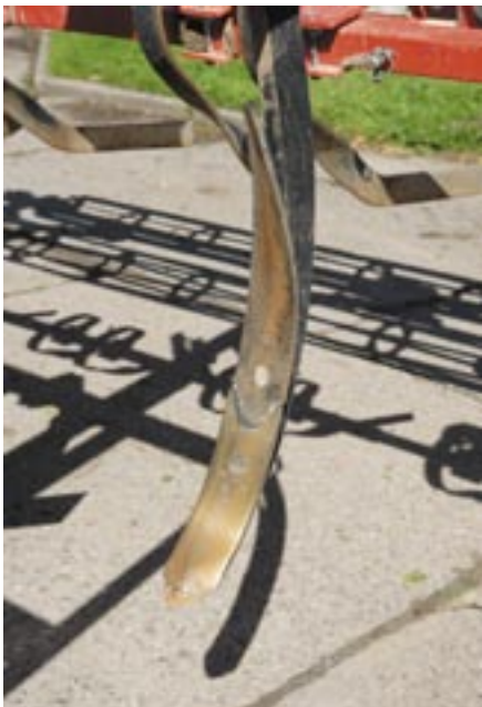
Das angeschrägte 8-cm-Schmalschar dient dem Titan zur tiefen Arbeit. Das einteilige Segment mit zwei Flügeln wird zur flachen Arbeit mit einer Schraube am Zinken befestigt.
