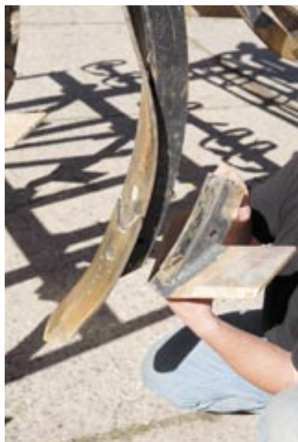
Das angeschrägte 8-cm-Schmalschar dient dem Titan zur tiefen Arbeit. Das einteilige Segment mit zwei Flügeln wird zur flachen Arbeit mit einer Schraube am Zinken befestigt.
