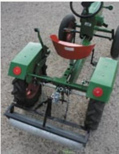
Die Walze lässt sich mit dem Hubwerk anheben und absenken. Die Splinte gehen allerdings schnell verloren.
