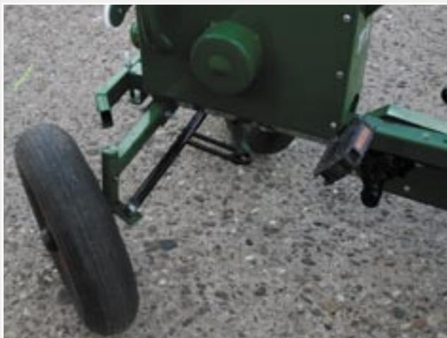
Die Lenkung mit dem großen Einschlag macht den Schlepper sehr wendig, kann allerdings aufgrund der fehlenden Endanschläge auch mal haken.
