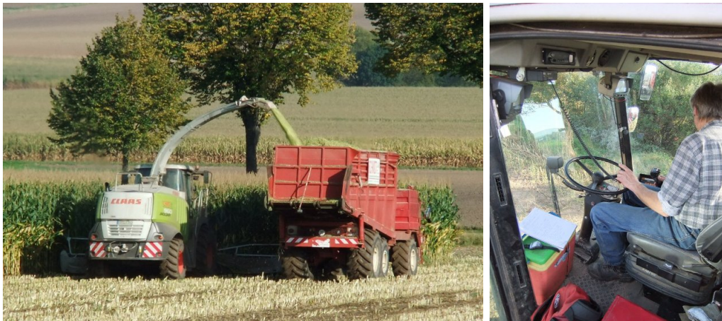
Abbildung 25: Der Aufbau fasst ca. 40 \text{ m}^3 , Die Kabinen könnten moderner sein.
