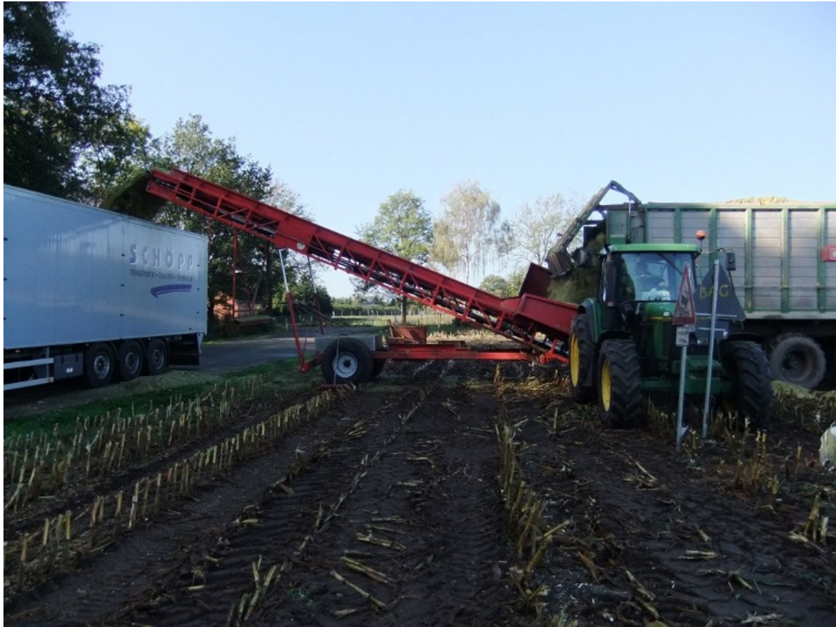
Abbildung 40: Das Benas-Überladeband überzeugte mit hoher Überladeleistung.
