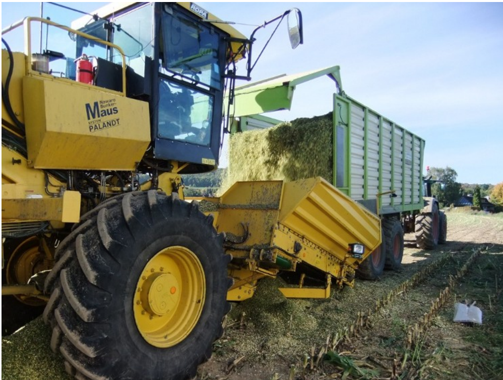
Abbildung 38: Zum Entladen fährt das Feldfahrzeug rückwärts an den Bunker heran.
