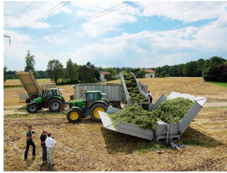
Abbildung 42: Die Fliegl Überladestation arbeitet mit einem klappbaren Vorratsbunker. (Foto: Hersteller)
