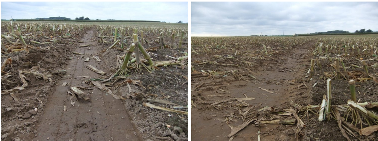
Abbildung 9: Bei zwei benachbarten Spuren wird der Unterschied deutlich: links LKW-Auflieger, rechts Fahrzeug mit Agrarbereifung; Abstand der beiden Spuren ca. 50 cm.
