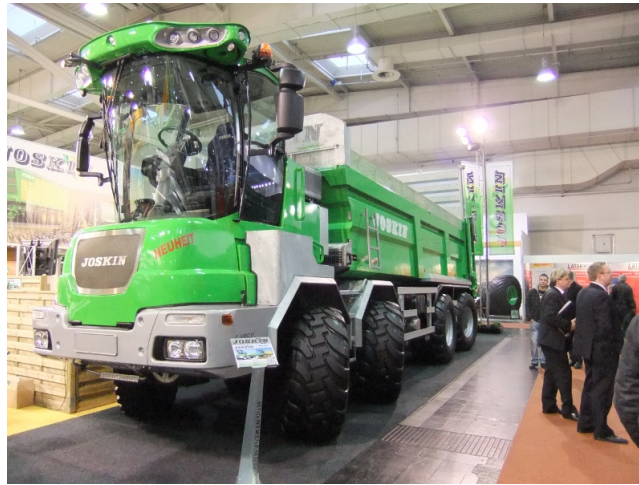
Abbildung 12: Beim Joskin Cargo Track wird neben den beiden ersten, auch die letzte Achse gelenkt. Die Kabine stammt von den New Holland Erntemaschinen.
