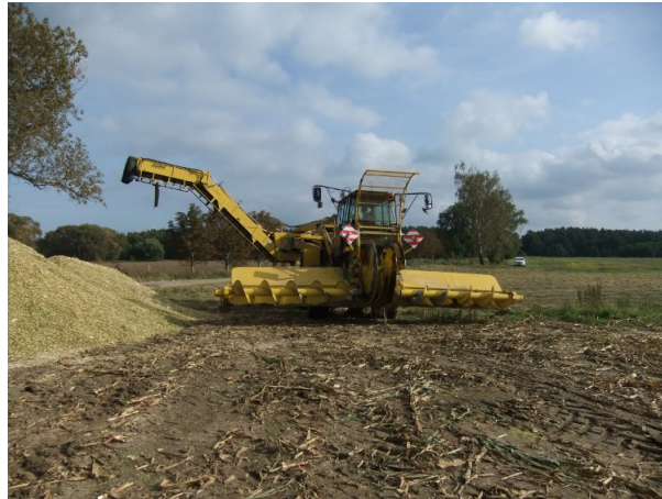
Abbildung 33: Die Rübenaufnahme wurde durch eine solche für Mais ersetzt und die Förderbänder abgedichtet.
