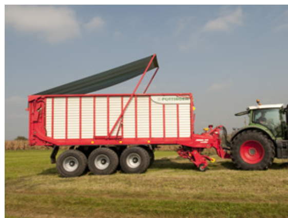
Abbildung 48: Für die landwirtschaftlichen Transportfahrzeuge sind fernbediente Abdecksysteme lieferbar. (Foto: Pöttinger)
