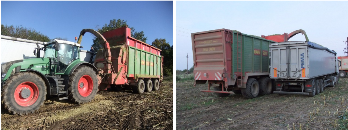
Abbildung 23: Mit dem Hawe-Wester SUW 5000 waren die besuchten Praktiker wegen der Prozessstabilität sehr zufrieden. Von Nachteil sind die hohen Kosten des Verfahrens.
