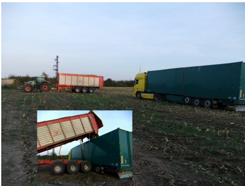
Abbildung 22: Durch die lose Schüttung wird ein Schubbodenauflieger von einem Fieldliner gut ausgefüllt.
