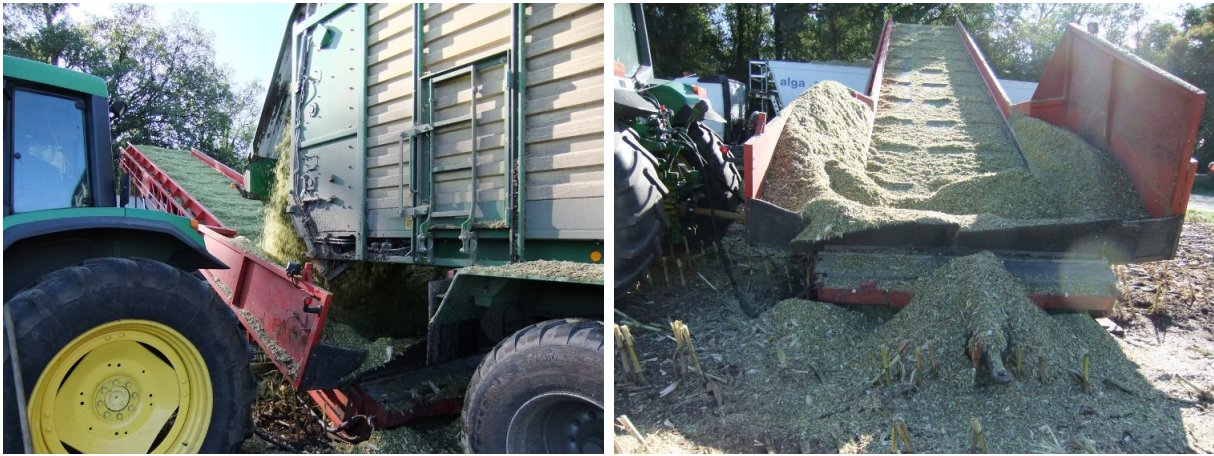
Abbildung 41: Das Band ist fast so breit wie ein Silagetransportwagen. Die Verluste sind äußerst gering und können manuell leicht aufgenommen werden.
