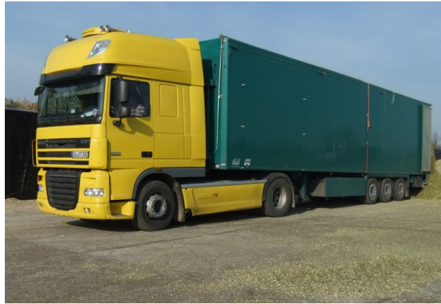
Abbildung 19: Sattelzüge mit Schubbodenaufleger bieten 90 bis 100 m 3 Volumen.
