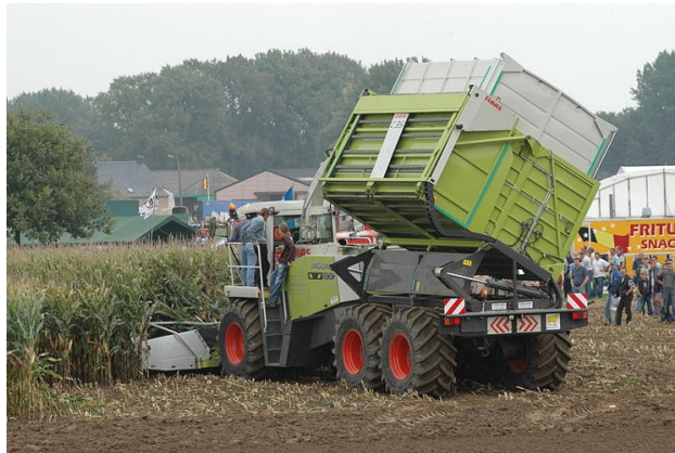
Abbildung 44: Der Bunkerhäcksler hat vor allem seinen Platz als Sondermaschine für extrem schwer befahrbare Flächen.
