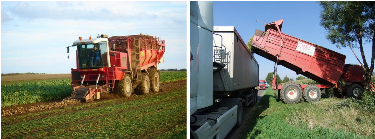
Abbildung 24: Diese Überladefahrzeuge basieren auf Rübensammlern von Gilles und wurden in Eigenleistung modifiziert
