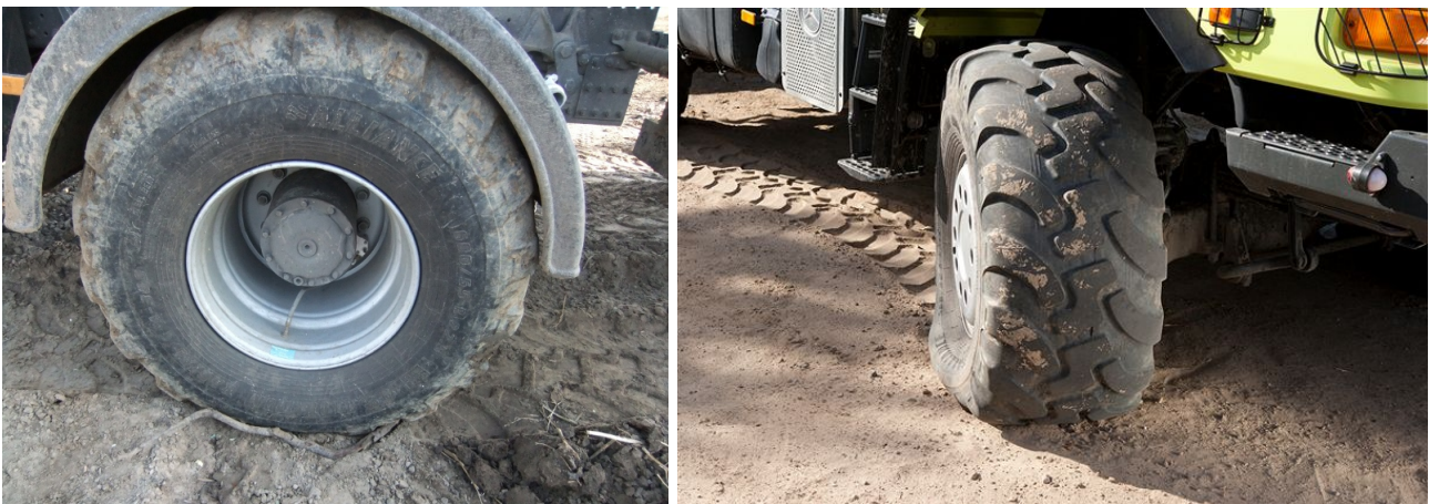
Abbildung 15: Beim Mercedes Zetros kann die Reifendruckregelanlage ab Werk geliefert werden. (Rechtes Foto: Hersteller)
