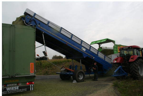
Abbildung 43: Das Überladeband von Becklönne ist "nur" 2 \text{ m} breit. (Bildquelle: BRÜSE, Redaktion profi)
