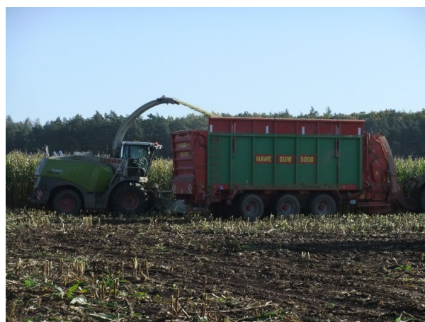
Abbildung 2: Erntemaschine und Transportfahrzeug fahren synchron.
