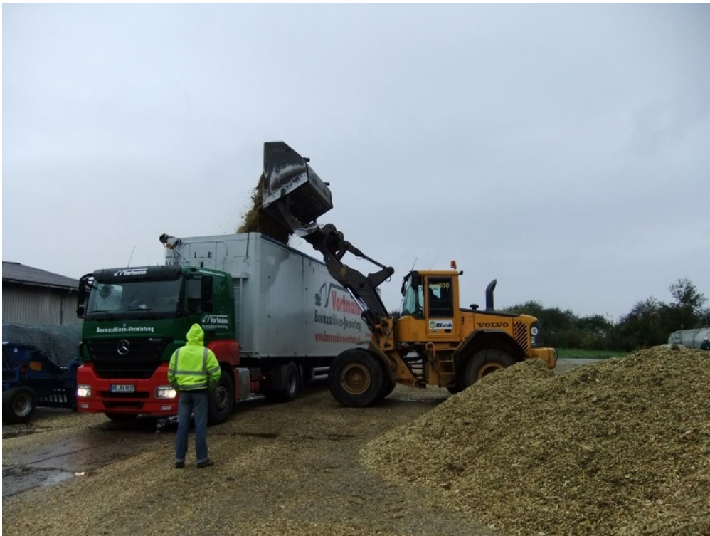
Abbildung 36: Das Überladen mit Radladern kann eine spontane und flexible Lösung darstellen.
