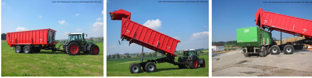
Abbildung 26: Der Demmler Überladewagen arbeitet mit der Abschiebetechnik (Foto: Hersteller)
