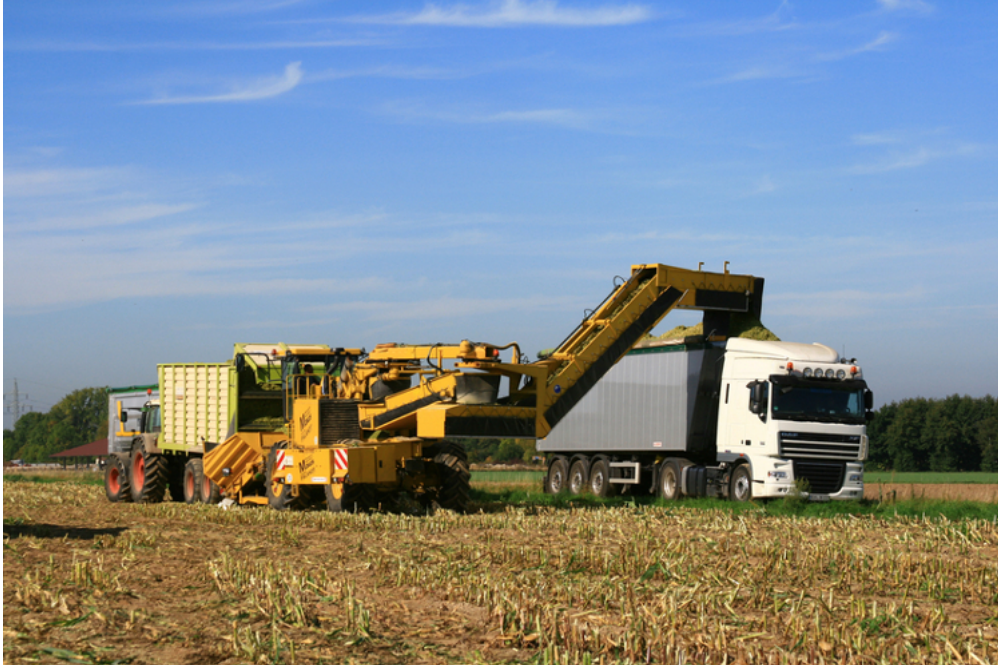
Abbildung 39: Mit dem langen Ausleger können auch Gräben überbrückt werden. (Foto: Alexander Uhlemann)
