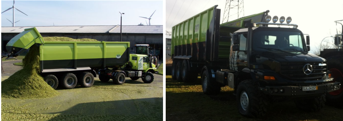
Abbildung 14: Der besichtigte Bruhns Secutor mit Abschiebeaufbau von SGT war eine Vorse- rienmaschine (links). Rechts eine der ersten Serienmaschinen mit PullBox.
