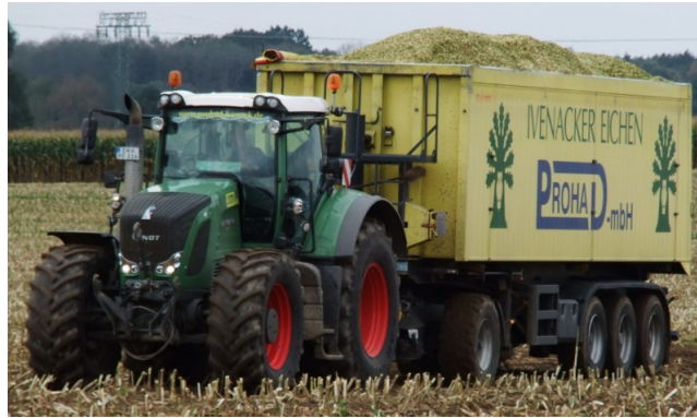
Abbildung 47: Wenn der Schüttkegel bis an die Bordwandoberkante reicht oder die Gefahr des Hinunterwehens besteht, muss abgeplant werden.
