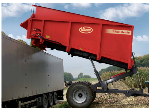
Abbildung 29: Der Vicon T-Rex Shuttle (Veenhuis Shuttle) fasst etwa 30 m 3 DIN. (Foto: Hersteller)
