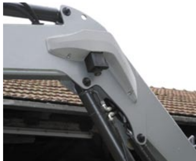
Die Leitungen sind in den Holmen und Komponenten (hier Schaltventil für die dritte Funktion) aufgeräumt platziert.
