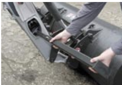
Die Parkposition der Abstellstützen im Querrohr (für mehr Platz bei hohen Bordwänden) hat uns in Sachen Handhabung nicht gut gefallen. Auch ist fraglich, wie lange die Kunststoff-Abdeckklappen am Querrohr dem harten Praxiseinsatz gewachsen sind.
