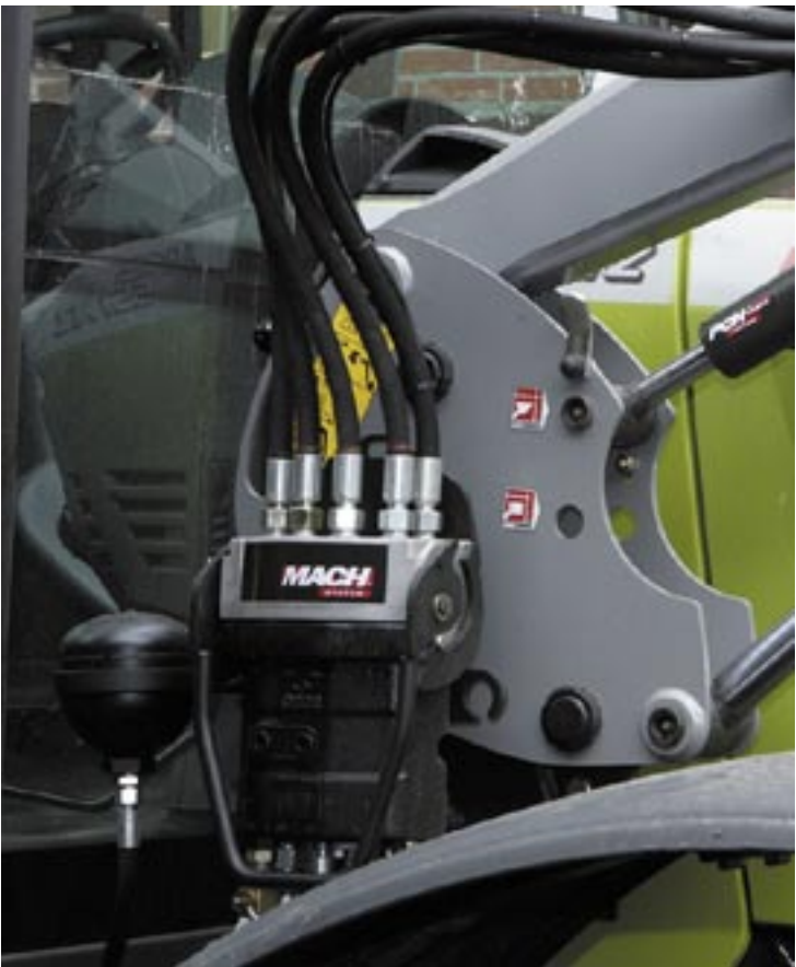
Der zusätzliche Hydraulikzylinder für die Parallelführung lässt sich an der Konsole zwischen Gabelbetrieb und Schaufelbetrieb umstecken. Leider ist dies mit Schraubarbeit verbunden, so dass eine ständige Anpassung in der Praxis unterbleibt. Die Stickstoffblase samt Absperrhahn neben der Multikupplung verbleibt bei abgebautem Lader am Schlepper.
