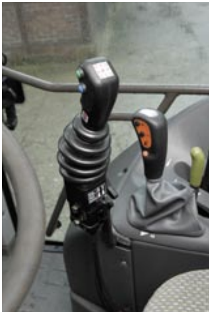
Der in der Neigung verstellbare „Pro-Pilot“-Joystick mit Tastern auf der linken Seite ließe sich noch besser bedienen, wenn er in Fahrtrichtung und nicht um rund 45° nach rechts verdreht montiert wäre (auf Wunsch möglich). Die Dosier- und Mischbarkeit der Funktionen ist gut. Dass man beim Absenken des Laders erst die Schwimmstellung und dann die Druckfunktion aktiviert, hat durchaus Vorteile.
