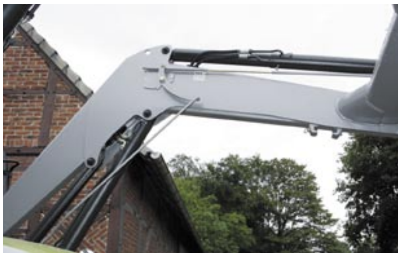
Das Gestänge für die Anzeige der Geräteeigung ist wegen der hydraulischen Parallelführung etwas aufwändiger, es lässt sich jedoch werkzeuglos einstellen.
