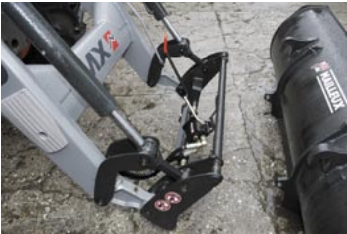
Die Werkzeuge lassen sich gut anbauen, da man (anders als hier gezeigt) den Schnellwechselrahmen komplett auskippen kann und so die Koppelpunkte gut im Blick hat. Die Multikupplung für hydraulische Werkzeuge (Aufpreis 225 Euro) ist am Schnellwechselrahmen montiert – positiv.
