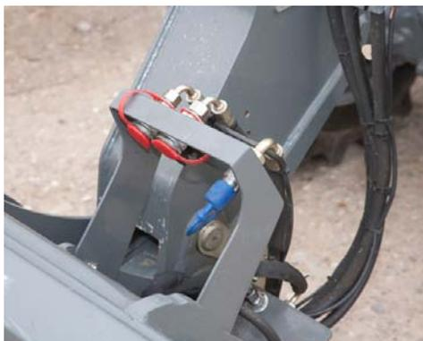
Die Ölkupplungen für die vierte Hydraulikfunktion sind fast vorbildlich am Schnellwechselrahmen montiert. Nur der für den Schutz gute Bügel über den Kupplungen behindert das Anschließen der Schläuche etwas. Die dritte Leitung ist der drucklose Rücklauf.
