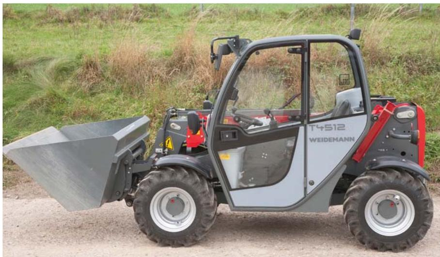
Alles wie bei einem ausgewachsenen Teleskoplader: mittlerer Telearm, Kabine links und Motor rechts daneben – nur alles viel kleiner. Der Weidemann T4512 ist der zierlichste Lader in seiner Klasse.
