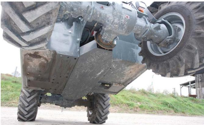
Von unten ist der Teelader vorbildlich mit einer geschlossenen Bodenplatte geschützt.
