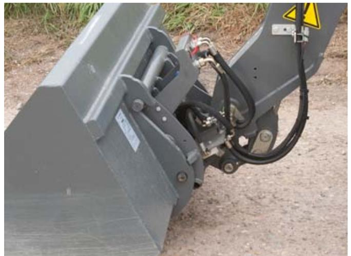
Der seitlich vorstehende Bolzen zeigt dem Fahrer an, dass das Werkzeug verriegelt ist. Zwischen Verriegelung und vierter Funktion wird komfortabel per Elektroventil umgeschaltet.
