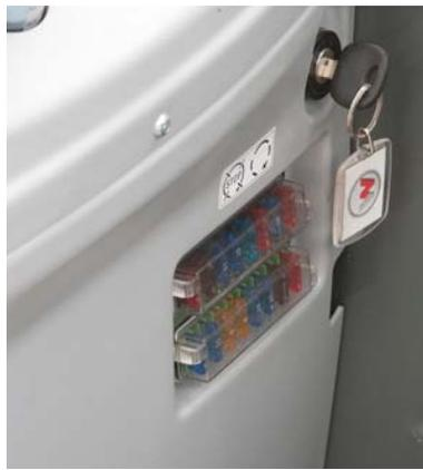
Die Sicherungen sind zentral unten in der Frontkonsole untergebracht.
