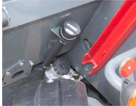
Hinter der Kabine ist der Einfüllstutzen für das Hydrauliköl gut zugänglich, die Anzeige für den Ölstand sitzt übersichtlich unten neben der Kabinentür.
