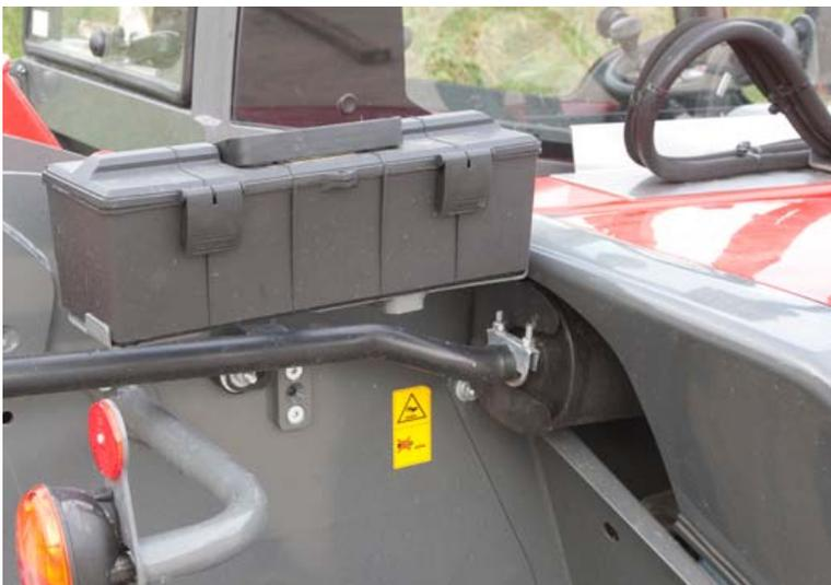
Auf Wunsch liefert Weidemann einen Werkzeugkasten aus Kunststoff mit, der in einer Aufnahme hinten an der Anlenkung des Telearms mitgeführt werden kann.
