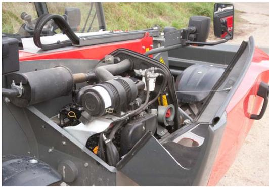
Der Dreizylinder-Turbomotor von Yanmar leistet im T4512 CC40 laut Weidemann 29 kW/40 PS. Für die tägliche Wartung öffnet man die Motorhaube zu sich hin. Für größere Aktionen lässt sich die Haube schnell abnehmen.
