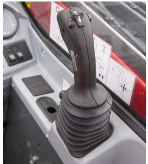
Der Joystick selbst beinhaltet alle Funktionen. Oben drauf sitzen ein Taster zur manuellen Schaltung der Fahrstufen (erfolgt auch automatisch) sowie ein Schiebeschalter für die Wendeschaltung.
