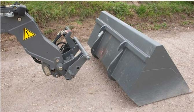
Der Anbau und Abbau der Arbeitswerkzeuge funktioniert auch dank der hydraulischen Werkzeugverriegelung reibungslos.
