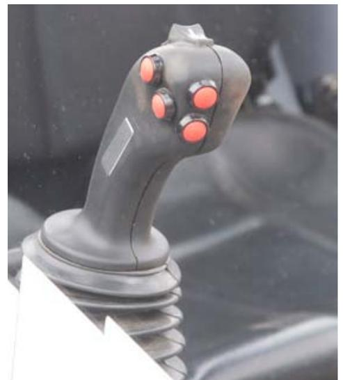
Die beiden Taster vorne am Hebel betätigen den Ein- und Ausschub des Telearms. Rechts am Hebel sitzen oben der Taster für die Aktivierung der vierten Hydraulikfunktion (oben) und unten der Taster für die Differenzialsperre.
