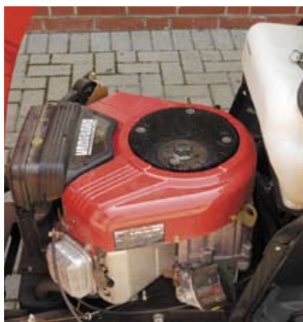
Im praktischen Einsatz passte der Motor von Briggs & Stratton, der laut Hersteller 16,7 PS leistet, gut zur Maschine. Der Benzverbrauch fiel im Test mit 3 l/h vergleichsweise niedrig aus.
