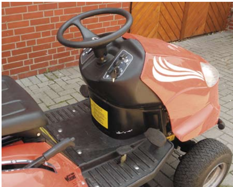
Eine fehlende Anfahrtsicherung zum Rückwärtsmähen erleichtert die Bedienung, gefährdet aber die Sicherheit. Aus Sicht der Ergonomie ist die Positionierung der beiden Fahrpedale noch verbesserungsfähig.
