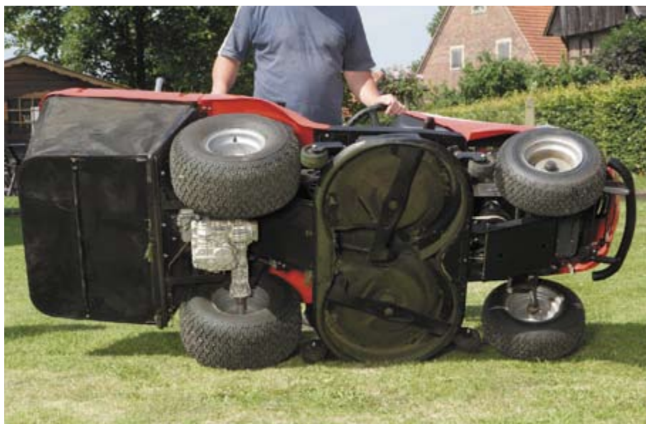
Das Mähwerk kommt auch mit hohen Gras gut klar. Allerdings sind die nebeneinander angeordneten Mähmesser bei Ansprechen der Abschersicherung in Gefahr.
