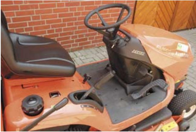
Die Armaturen sind bei Taglicht schlecht zu erkennen, und das Pedal für den Hydrostat ist nicht gerade ergonomisch. Der Hebel rechts vom Sitz zum Ausheben des Mähdecks ist trotz eines unterstützenden Gasdruckdämpfers schwergängig.
