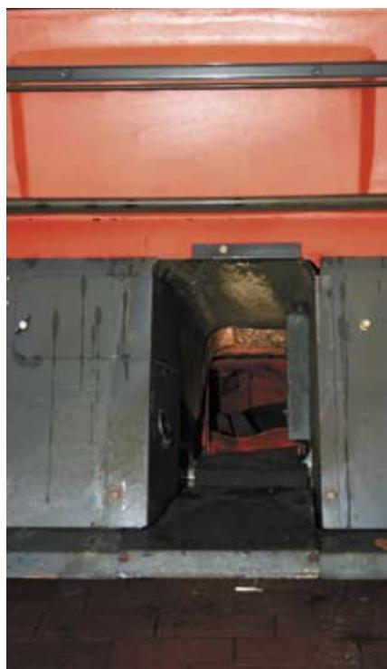
Verstopfungen, die beim GR 1600-II aufgrund des großen Auswurfkanals sehr selten auftreten, lassen sich durch eine Bodenklappe relativ einfach beseitigen.
