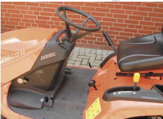
Der Drehknopf zwischen den Beinen des Fahrers gehört zur gut abgestuften Schnitthöhenverstellung. Scharfe Kanten unter dem Kotflügel brachten die Verarbeitung in Misskredit.
