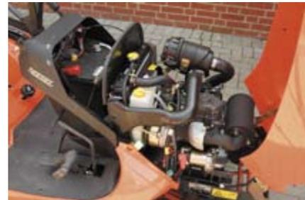
Der Zweizylinder-Diesel von Kubota zeigte sich sparsam und drehmomentstark. Dass der Motor seine Luft aus dem Fußraum des Fahrers ansaugt, ist nur eine kleine Besonderheit des Fahrzeugs.
