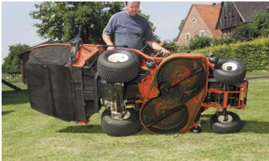
Gut für den Bauernhof: Die Messer sind versetzt angeordnet. Das mindert die Gefahr größerer Schäden durch Fremdkörper, z.B. bei Steinen.
