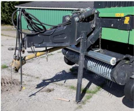
Beim RotoMaster gibt es keine vernünftige Schlauchgarderobe oder gar einen „Parkplatz“ für das Tellus-Terminal. Bei der breiten Pickup mit ungesteuerten, V-förmig angeordneten Zinken kann schon mal Gras in den Ecken hängen bleiben.
