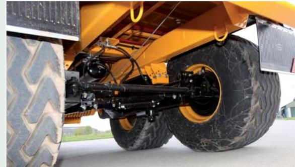
Das Pendelfahrwerk hat keine Federung, aber eine Nachlauflenkung.
