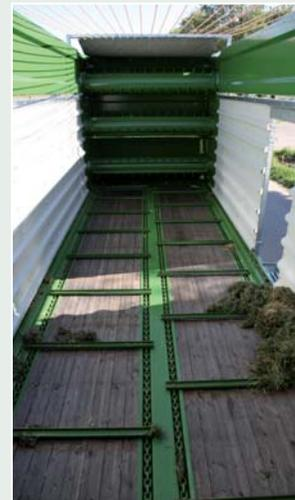
Der Laderaum fasst nach unseren Messungen 30,5 m<sup>3</sup> und ist laut Bergmann auch für den Häckselguttransport zugelassen. Die Kratzbodengeschwindigkeit ist mit 10,9 m/min okay, das Entladen mit den drei Dosierwalzen geht zügig.
