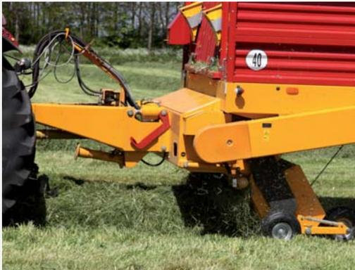
Zusammen mit der hydraulisch angetriebenen Zuführrolle leistete die gezogene Pickup hervorragende Arbeit. Serienmäßig gibt es einen hydraulischen Stützfuß und eine Schlauchgarderobe, Schuitemaker sollte nur noch die Schläuche entsprechend markieren und einen „Parkplatz“ für das Terminal vorsehen.
