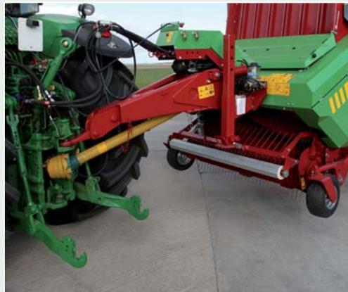
Von der Schlauchgarderobe bis zum Platz fürs Bedienterminal, bei der Super-Vitesse ist alles durchdacht. Die gesteuerte Pickup ist sicher nicht zu breit, man kann sie aber gut einsehen – und sie arbeitet sauber.
