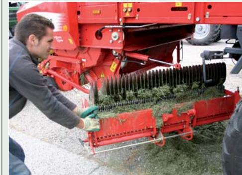
Zum Wechsel der 39 Messer müssen Sie sowohl beim Ausklappen als auch beim Entnehmen der Messer wissen, wie Sie vorgehen. Da sich der Messerboden seitlich ausschneiden lässt, sind die Messer sehr einfach aus- und wieder eingebaut.
