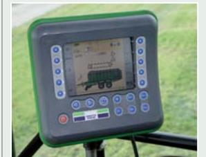
Der Wagen hatte das farbige Tellus-ISO-Bus-Terminal. Positiv ist die klare Anzeige aller Funktionen, die Logik könnte aber besser sein. So muss man z. B. mehrer Tasten drücken, um die Kratzbodengeschwindigkeit zu ändern.
