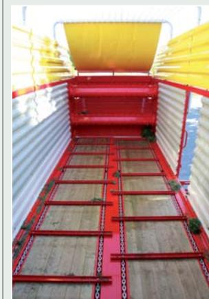
Der Laderaum fasst knapp 30 Kubikmeter, und wir hatten den Wagen mit zwei Dosierwalzen.
