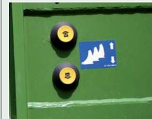
Der Messerboden kann seitlich am Wagen über Taster bedient werden.
