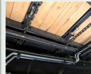
Der Kratzboden muss manuell gespannt werden. Aber für die insgesamt 37 Schmiernippel bietet die Kurzanleitung eine prima Übersicht.
