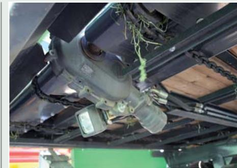
Der Kratzbodenantrieb ist mittig angeordnet, um die Torsionskräfte so gering wie möglich zu halten. Vorwärts machte der Kratzboden maximal 9,2 m/min (heute laut Deutz-Fahr 10,9 m/min).
