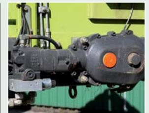
Der Ölmotor vom Kratzboden sitzt auf der linken Seite. Mit nur 8 m/min könnte er den Boden aber schneller drehen.
