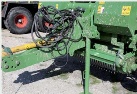
Auf der linken Seite sitzen der zweite Ölmotor für den Kratzboden sowie der Dosierwalzenantrieb. Dieser hat keine zusätzliche Sicherung und überträgt die volle Leistung von vorne.
