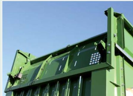
Die Ladeautomatik sowie die Führung und Pressung des Erntegutes funktionieren dank der Kombiwagen-Klappe (a. W. hydraulisch) prima.
