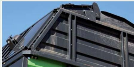
Durch die gute Ladeklappe verliert man kein Gras, egal wie voll man den Wagen macht. Die Ladeautomatik arbeitet mit einem Sensor oben in der Klappe. Das funktioniert tadellos.
