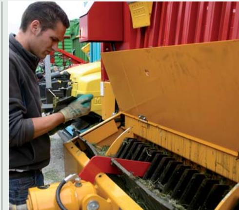
Die 39 Messer haben eine dreigeteilte Block-sicherung und können beidseitig genutzt werden. Zum Wechseln werden sie (von der Kabine aus) ausgeschwenkt, um sie dann im Stehen entnehmen zu können. Man muss allerdings einmal um den Schlepper herumlaufen.
