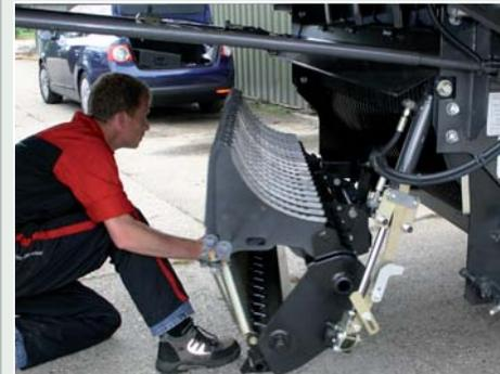
Die 40 Messer können in zwei Gruppen geschaltet werden. Die Einzelsicherung arbeitet mit separaten Federn, die alle einzeln geöffnet werden. Gut, dass sich der Messerboden dazu seitlich ausschwenken lässt, da der Wechsel im Vergleich am längsten dauert.
