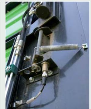
Die Endabschaltung des Kratzbodens erfolgt nicht über die untere Dosierwalze, sondern über separate Sensorklappen. Einen Nachteil beim Terminal ist, dass Sie mehrere Knöpfe drücken müssen, um die Kratzbodengeschwindigkeit einzustellen.
