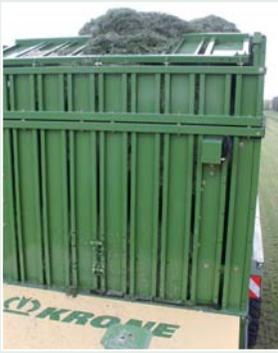
Die Ladeautomatik mit zwei Sensoren funktionierte prima, es kann aber oben Material auf der Sensorklappe liegen bleiben.
