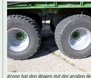
Krone hat den Wagen mit der großen Bereifung und dem neuen Tandemaggregat mit hydraulischem Ausgleich geliefert. Zusammen mit der Untenanhängung sind so 23 t Gesamtgewicht möglich.
