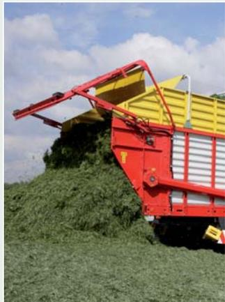
Um eine kontinuierliche Entladung zu gewährleisten, muss die Federbelastung der unteren Dosierwalze richtig eingestellt sein. Sonst spricht der Sensor an und stoppt den Kratzboden. Die Sicht in den Laderaum ist gut, und im Vergleich zu den anderen bleibt weniger häufig Gras an der Vorderwand „kleben“.
