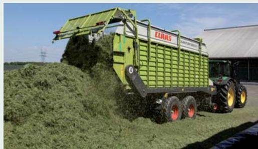
Der Antrieb der beiden Dosierwalzen erfolgt von der rechten Seite. Das Entladen startet dank der Automatikfunktion mit nur einem Knopfdruck, wenn die Pickup angehoben ist und die Heckklappe geöffnet wird.
