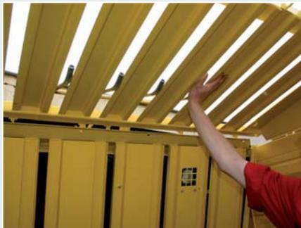
Eine Besonderheit ist die Wahl zwischen zwei verschiedenen Ladeautomatiken: entweder über Finger, die von oben in den Laderaum ragen oder einen Bodenklappensensor. Bei der Bodenklappe wird das Futter stärker verdichtet.
