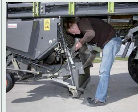
Der Messerboden lässt sich auch beim Quantum per Knopfdruck absenken. Die 40 Messer sind in einer Ebene angeordnet und haben Einzelsicherungen. Mit einem Hebel werden alle Messer entriegelt, lediglich der Freiraum zum Entnehmen der Messer ist ziemlich eng.
