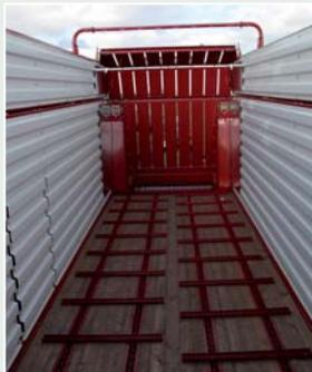
Die Ladeautomatik mit einer Tastgabel oben im Laderaum arbeitet dynamisch: Je weiter sie ausgelenkt wird, desto schneller dreht sich der Kratzboden.
