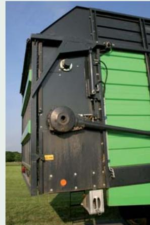
Der Antrieb der Dosierwalzen erfolgt von rechts über eine Welle mit Kegelradgetriebe.
