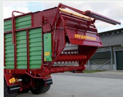
Die Heckklappe öffnet in der ersten Stufe nur im unteren Bereich, um eine gleichmäßige Gutablage sicher zu stellen.
