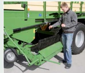
Krone hat eine Messergruppenschaltung (0/20/21/41), und dank einfach schwenkbarem Messerbalken geht der Messerwechsel beim MX am schnellsten.
