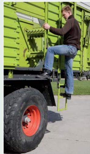
Der Zugang zum Laderraum erfordert etwas Akrobatik, da die Leiter nicht direkt unter der Tür, sondern versetzt angeordnet ist.
