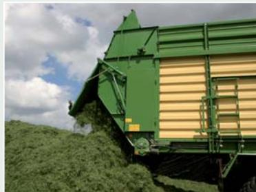
Der Kratzbodenantrieb erfolgt von beiden Seiten. Wenn die Klappe öffnet, stellt sich oben auch ein Schild zur Gutführung auf – prima.
