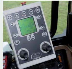
Die Bedieneinheit mit den beiden Joysticks ist recht praktisch, der Hebel für die Pickup sollte aber rechts liegen, und die Tasten für den Wechsel zwischen Lade- und Entlademenü sind nicht eindeutig erkennbar. Eine ISO-Bus-Bedienung gibt es nicht.
