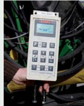
Die übersichtliche Bedienbox hat einige versteckte Automatikfunktionen. So hebt und senkt die Pickup mit nur einem kurzen Tastendruck. Das Display ist zu klein, um alle Funktionen und z. B. die Kratzbodengeschwindigkeit klar anzuzeigen.
