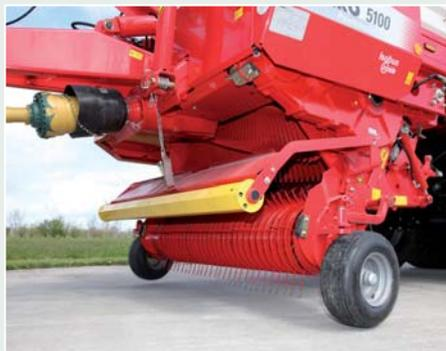
Die Pickup mit Kurvenbahnsteuerung und Rollenniederhalter funktioniert gut, ist aber schmal.
