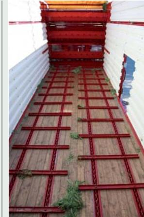
Da die Heckklappe in zwei Stufen öffnet, kann man zusammen mit den drei Dosierwalzen einen gleichmäßigen und lockeren Teppich auf dem Silo ablegen. Erleichtert wird die Sache durch den Entlademodus I (Achse zu, Deichsel hoch) und II (automatische Reversierung, Klappe auf usw.).
