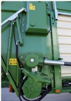
Der Kratzbodenantrieb mit zwei Ölmotoren hat eine automatische 2-Stufen-Schaltung. Der Antrieb der drei Dosierwalzen erfolgt entlang der rechten Seite über eine Welle mit Winkelgetriebe.
