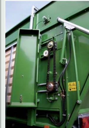
Auf der rechten Seite sorgt eine Kette für den Antrieb von der ersten zur zweiten Dosierwalze. Links geht es dann per Kette hoch zur obersten Walze. Die untere Walze ist beweglich und stoppt den Kratzboden, wenn sie gegen die Federn zurückgedrückt wird.
