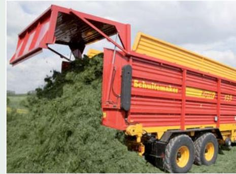
Auch zum Entladen gibt es keine Automatik. Wer will, kann aber Funktionen wie das Starten und Abstellen der Dosierwalzen oder des Kratzbodens an das Öffnen oder Schließen der Heckklappe koppeln.
