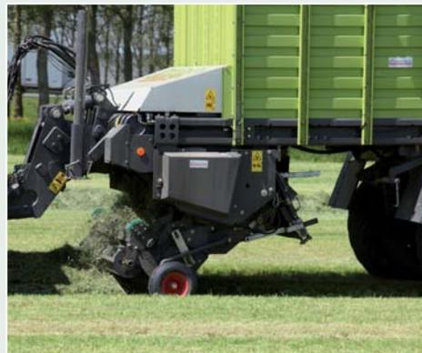
Die vom Schlepper sehr gut einsehbare Pickup mit Kurvenbahn war mit nur 151 cm die schmalste im Vergleich. Dank Doppelrollen-Niederhalter leistet sie aber saubere Arbeit, und die Übergabe an den Rotor funktioniert einwandfrei. Die Schlauch- und Kabelführung ist mangelhaft, eine Schlauchgarderobe fehlte komplett.
