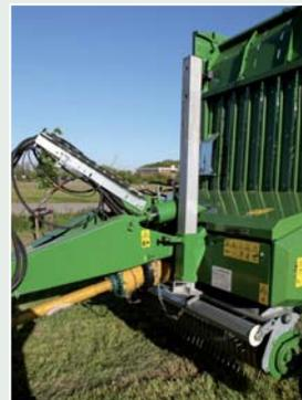
Beim Raptor gibt es schöne Details, wie die Garderobe für die (gut gekennzeichneten) Öl- und Luftschläuche, Kabel und Stecker. Lediglich der dicke Rückführschlauch passt nicht, und die massive Stütze ist fast zu schwer. Bei breiten Schwaden kann bei der ungesteuerten Pickup (mit serienmäßigem Rollenniederhalter) in den Ecken Gras hängen bleiben.
