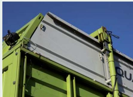
Die Ladeautomatik arbeitet über einen Tastbügel oben im Laderraum. Das funktionierte gut. Die Endabschaltung hinten an der unteren Dosierwalze versagte dagegen einmal ihren Dienst.
