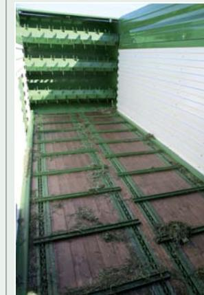
Mit den drei Dosierwalzen kommt Krone seinem Ziel – mit Dosierwalzen genauso schnell zu entladen wie ohne – recht nahe, zumal auch der Kratzboden mit 10,9 m/min zügig dreht.
