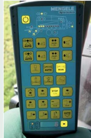
Die neue Bedieneinheit „Bull-Tronic“ hat kein Display, kann aber parallel zum ISO-Terminal im Schlepper genutzt werden. Die gut beschrifteten, unterschiedlich gestalteten Knöpfe sind in logischen Gruppen zusammengefasst.
