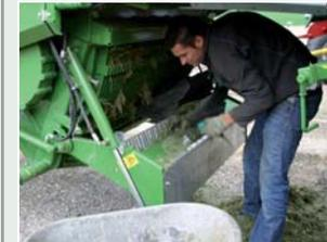
Die 41 Messer sitzen auf einer Ebene, sind einzeln abgesichert und können mit nur einem Handgriff entnommen werden. Das geht so schnell, dass man nicht mal einen seitlich schwenkbaren Messerboden vermisst.
