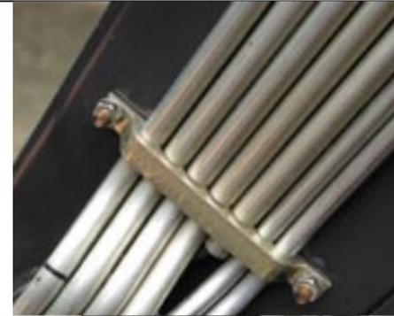
Die auf der Innenseite des rechten Holms exakt verlegten und eloxierten Leitungen für die Öl- und Elektroleitungen stören die Sicht weniger...
