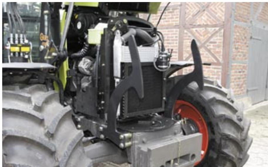
*Alle Wartungsstellen am Claas Ares 557 waren bei angebauter Schwinge gut erreichbar. Der Luftfilter lässt sich bei mittelhoher Schwingenposition entnehmen.*
