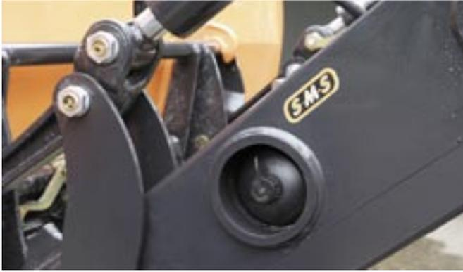
*Geschützt im Querrohr sind die beiden Stickstoffblasen der „SMS“-Schwingungsdämpfung untergebracht.*
