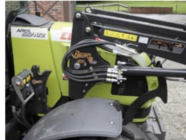
Beim Frontladeranbau freut man sich über die automatische Verriegelung der Konsolenhälften „Top-Block K-II“. Allerdings muss man aufgrund der engen Schwinge aufpassen, dass man nicht mit dem Anfahrerschutz oder der Schlepperhaube kollidiert. Fotos: Tovornik
