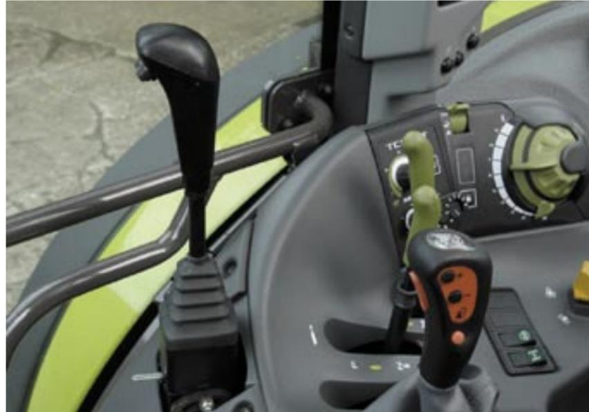
Den Joystick hatte Hauer zwar verstellbar und schön aufgeräumt vorne rechts in der Konsole des Claas-Schleppers eingebaut. Für eine entspannte Bedienung ist diese Position allerdings zu weit vom Fahrer entfernt. Gut gefallen hat uns die Dosierung und Mischbarkeit der Funktionen.
