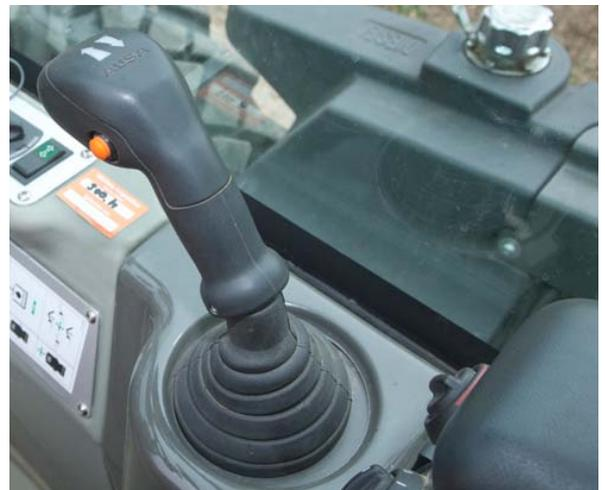
Dank einer gepolsterten Armlehne ist die Bedienung des Joysticks sehr ergonomisch. Oben auf dem Joystick ist die Fahrtrichtungsanzeige integriert. Links am Hebel sitzt der Taster, der die Teleskopfunktion des Arms per Rechts-/Links-Bewegung des Joysticks aktiviert.
