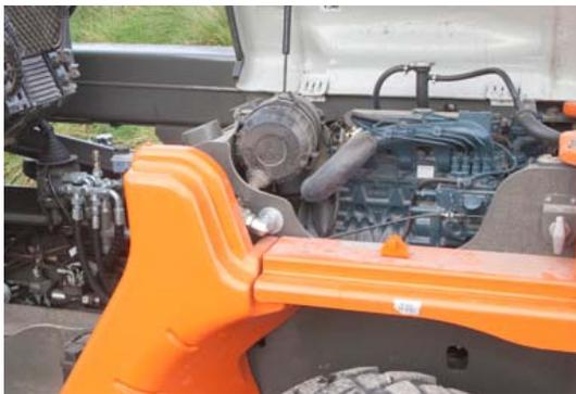
Der Saugmotor mit vier Zylindern von Kubota hat eine Leistung von 36,5 kW/50 PS (nach ISO 14396).
