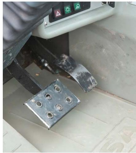
Gas- und kombiniertes Inch-/Bremspedal haben eine gute Stellung und lassen sich gut bedienen.
