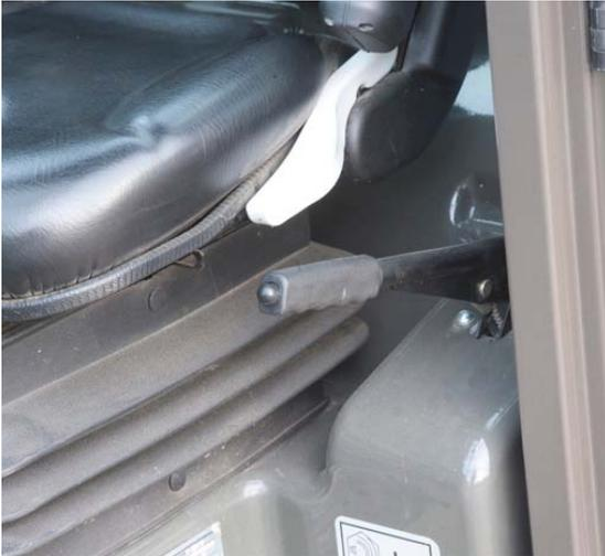
Einfach, aber ordentlich zu bedienen: die Handbremse mit konventionellem Rastenhebel.
