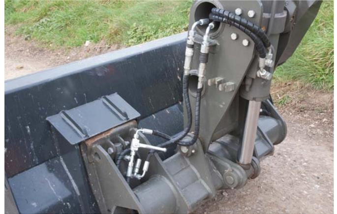
Will man mit hydraulischen Werkzeugen arbeiten, müssen die Ölleitungen der hydraulischen Werkzeugverriegelung entkoppelt werden.
