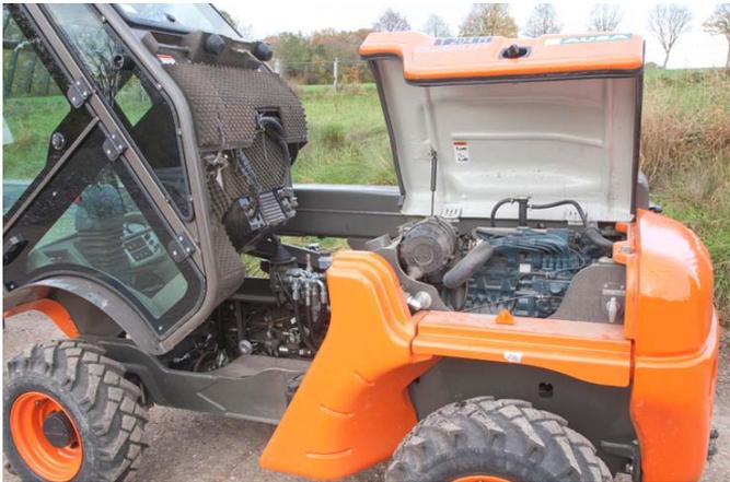
Dank der kippbaren Kabine ist die Zugänglichkeit für Wartungs- und Reparaturarbeiten beispielhaft.
