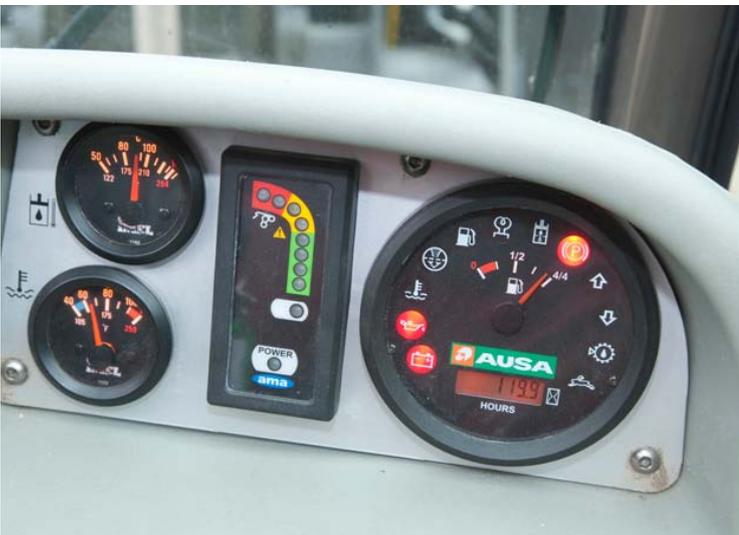
Die Lastanzeige sitzt zwischen den Temperaturanzeigen für Kühlwasser und Hydrauliköl (links) sowie dem Rundinstrument mit Stundenzähler, Dieseltankanzeige und Warnleuchten (rechts).
