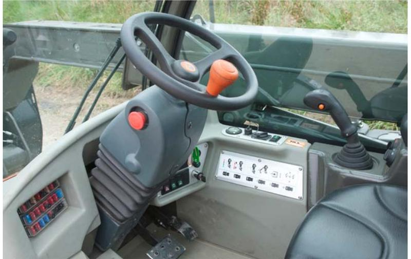
Die Lenksäule ist nicht verstellbar. Aber wir konnten mit der Lenkradposition gut leben. Der rote Knopf links an der Lenksäule ist ein Notaus-Schalter.
