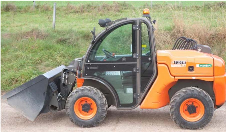
Kennzeichen für den Ausa Taurulift sind der auf der rechten Seite angelegte Telearm, der Heckmotor sowie die vorne angeordnete Kabine.
