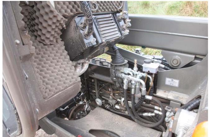
Bei gekippter Kabine sind die Hydraulikkomponenten sowie die Batterie und der Wärmetauscher der Klimaanlage (Wunschausstattung) komfortabel zugänglich.
