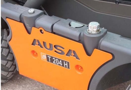
Dieseltank (vorne) und Hydraulik-Öltank (dahinter mit übersichtlichem Schauglas) sind auf der rechten Maschinenseite hinter einer stabilen Stahlplatte untergebracht.
