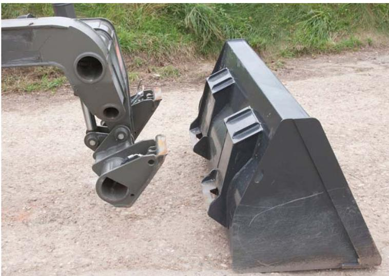
Die Kopplung des Werkzeugs geht mit zwei Anbauplatten und hydraulischer Verriegelung in Ordnung.
