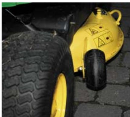
Die breiten Tasträder führen das Mähwerk gut über den Rasen. Schade nur, dass die Halterungen für die Räder für den praktischen Einsatz nicht stabil genug sind. Bei Kurvenfahrt sollte das Mähwerk stets angehoben werden.
