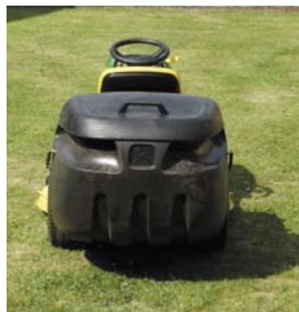
Die 300 Liter große Grasfang-Hartbox wirkt schnittig. Der Füllstand lässt sich aber nicht von außen kontrollieren. Mit 23 kg im Test ist das effektive Fangvolumen unterdurchschnittlich; bei der Demontage des Fangkorbs besteht die Gefahr, dass sich Federn lösen.
