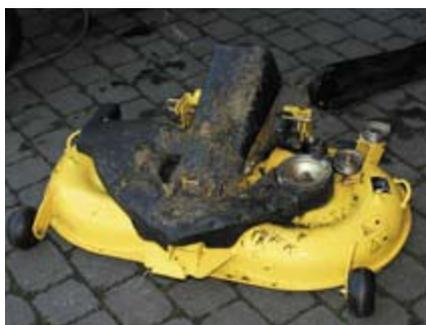
Das Mähwerk verstopfte häufiger, selbst bei trockenem Wetter und saftig grünem Rasen musste deshalb mit einer langen Stange der Wurfkanal gereinigt werden. Da der vordere Kanal den hinteren überragt, verliert der Mäher Gras auf den Rasen.
