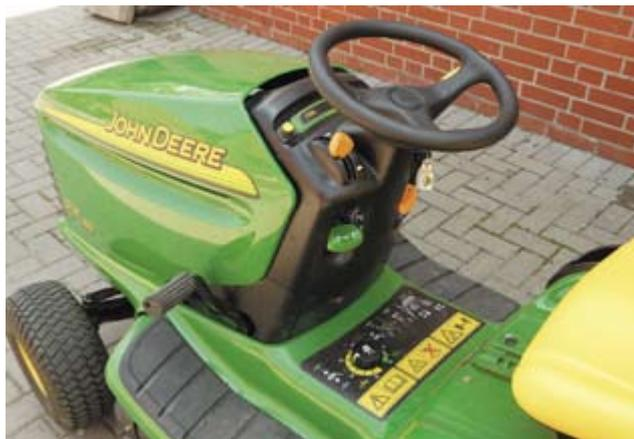
Um das mit dem linken Fuß leicht auszuhebende Mähdeck zu arretieren, ist ein zweiter Handgriff nötig, um die grüne Platte unterhalb des Lenkrads zu betätigen. Der gelbe Knopf am Armaturenbrett gehört zur Sicherheitsabschaltung bei eingeschaltetem Mähwerk. Er muss vor jeder Rückwärtsfahrt gedrückt werden, sonst schaltet das Mähwerk ab.
