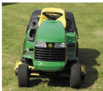
*Von vorne sieht der Mäher gut aus, die Scheinwerfer sind jedoch nicht spritzwasserfest. In jedem Fall empfehlenswert ist die optional erhältliche Stoßstange, denn bei einem Rempel gegen die Schaukel ist die komplett in Hartkunststoff gefertigte, fast 200 Euro teure Motorhaube schnell zerstört.*
