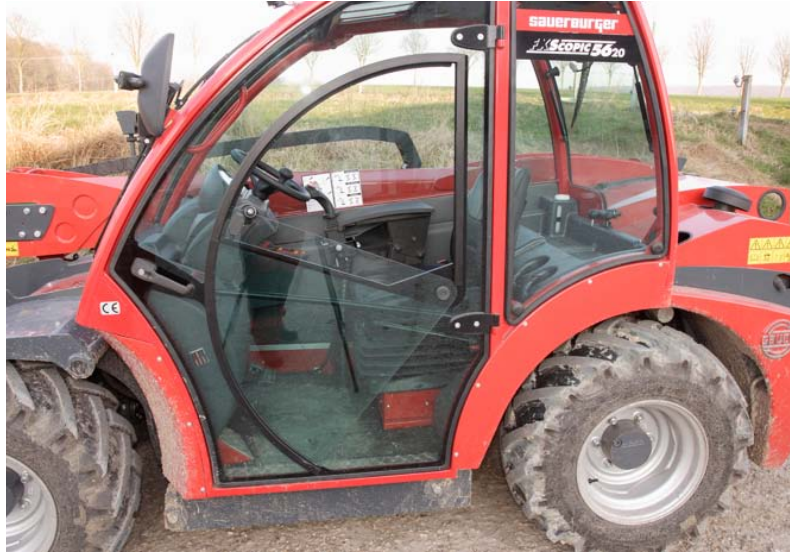
Pfiffig gelöst ist das drehbare und in vier Positionen arretierbare Fenster in der Kabinentür.
