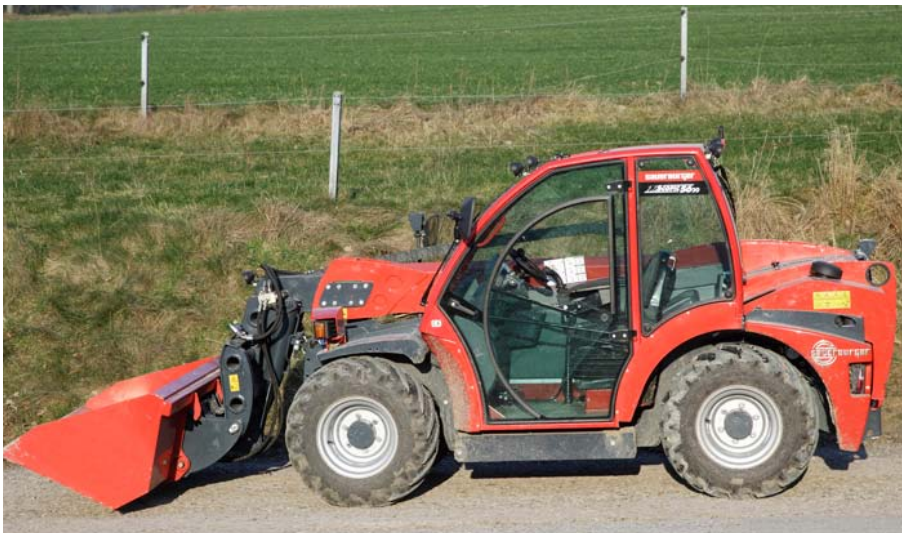
Der FXScopic 5620 von Sauerburger arbeitet mit einem Heckmotor und nach rechts versetztem Telearm. Aufgrund seiner mit über 4 m großen Baulänge ist die Kabine zwischen den Achsen positioniert.
