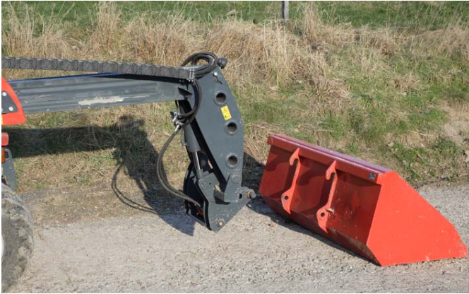
Nicht nur beim Werkzeuganbau behindert die massive Konstruktion im Bereich Werkzeugträger und Kippzylinder die Sicht. Der Anbau selbst geht in Ordnung, für die hydraulische Verriegelung sollte aber eine echte Zwei-Hand-Bedienung verbaut werden.
