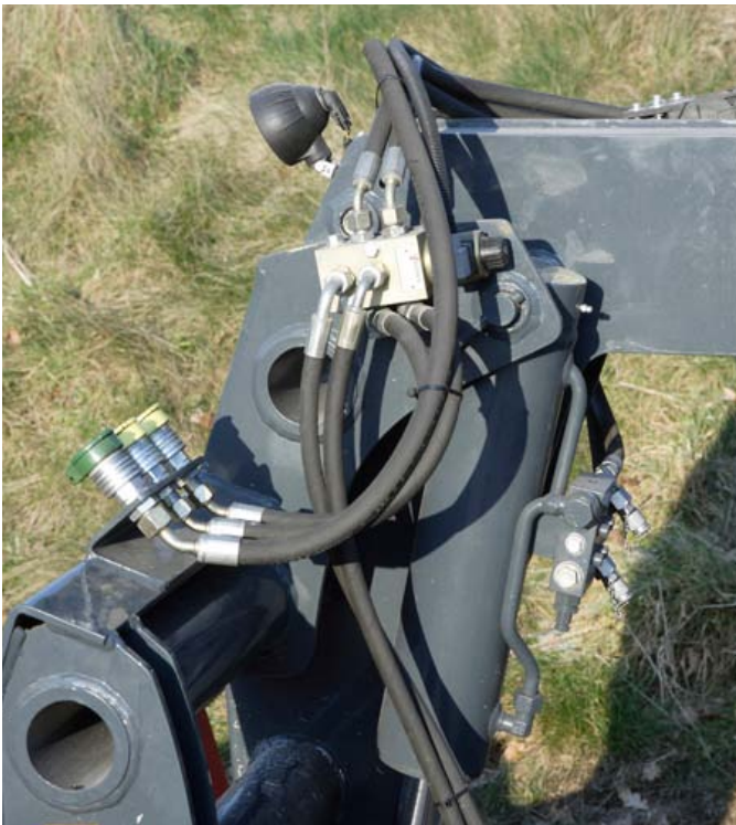
Weil die Ölkupplungen für die vierte Hydraulikfunktion fix und weit oben montiert sind, muss das hydraulische Werkzeug mit langen Schläuchen ausgestattet sein – Gefahr von Schlauchbeschädigungen. Gut gefallen uns der zusätzliche drucklose Rücklauf sowie das Magnetventil zum Umschalten zwischen Werkzeugverriegelung und vierter Funktion.
