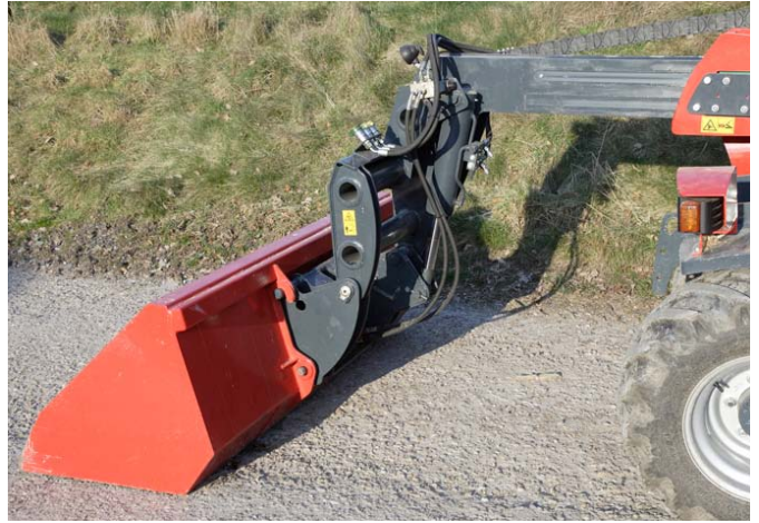
Ob das Werkzeug verriegelt ist, wird durch den seitlich herausstehenden Bolzen angezeigt. Aus dieser Perspektive wird der wuchtige Teleskopvorderbau besonders deutlich.
