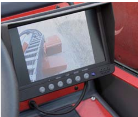
Die Konstruktion macht den FXScopic nicht zum übersichtlichsten Teelader. Aus diesem Grund ist das gute Überwachungspaket mit Front- und Heckkamera sowie automatisch umschaltendem Farbdisplay sehr zu empfehlen. Die Heckkamera erhält für ein besseres Sichtfeld noch eine andere Position.
