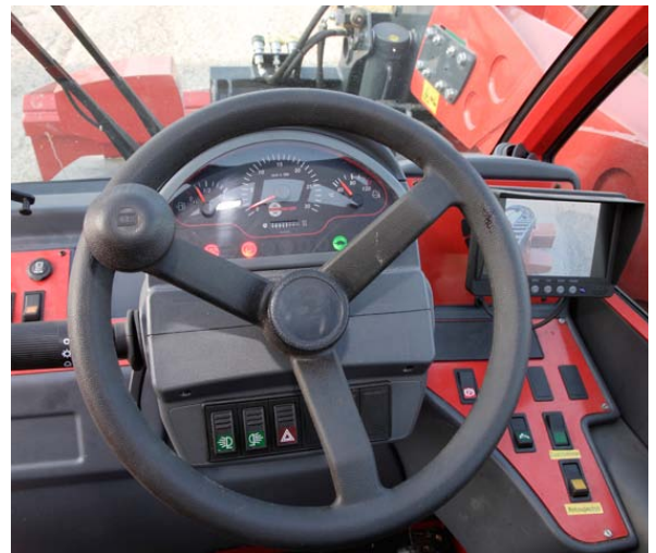
Die Mittelconsole bietet eine vollständige Instrumentierung. Die Schalter links und rechts neben sowie auf der Lenksäule sind etwas verstreut aber zum Teil unterleuchtet und sinnvoll gruppiert. Eine Lastanzeige ist zur Serie ebenfalls vorgesehen.
