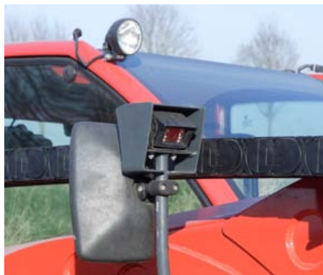
Die Konstruktion macht den FXScopic nicht zum übersichtlichsten Teelader. Aus diesem Grund ist das gute Überwachungspaket mit Front- und Heckkamera sowie automatisch umschaltendem Farbdisplay sehr zu empfehlen. Die Heckkamera erhält für ein besseres Sichtfeld noch eine andere Position.
