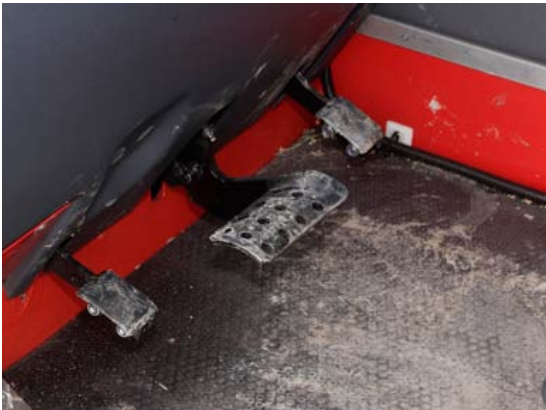
Im Fußraum finden sich drei Pedale zum Inchen des Fahr-antriebs (links), zum Bremsen (mittig) und zum Gasgeben (rechts). Das Bremspedal steht etwas zu hoch, Inch- und Gaspedal sind etwas klein.
