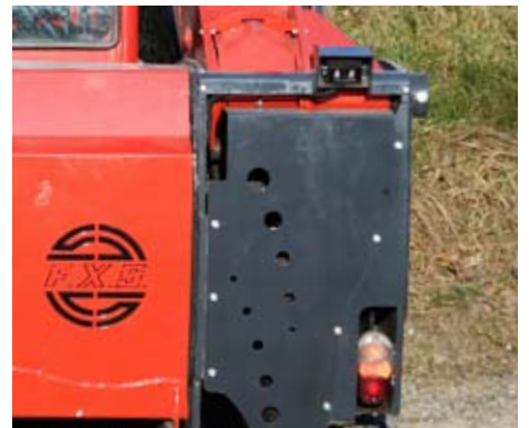
Die Konstruktion macht den FXScopic nicht zum übersichtlichsten Teelader. Aus diesem Grund ist das gute Überwachungspaket mit Front- und Heckkamera sowie automatisch umschaltendem Farbdisplay sehr zu empfehlen. Die Heckkamera erhält für ein besseres Sichtfeld noch eine andere Position.
