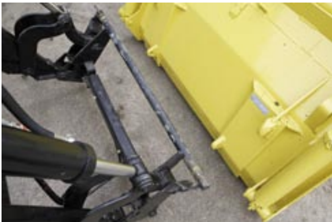
Beim Werkzeuganbau lässt sich der Rahmen wegen der Einführhilfen nicht komplett auskippen. Man kann aber außen an der schmalen Schwinge vorbeischauchen, um die Koppelpunkte einzusehen.
