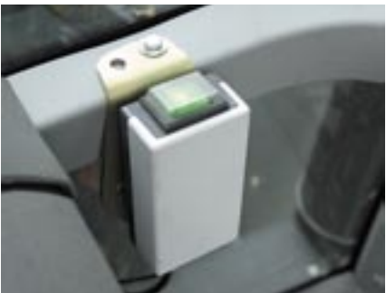
Der recht voluminöse Schaltkasten für die hydraulische Werkzeugverriegelung ist etwas lieblos in der Schlepperkabine untergebracht.
