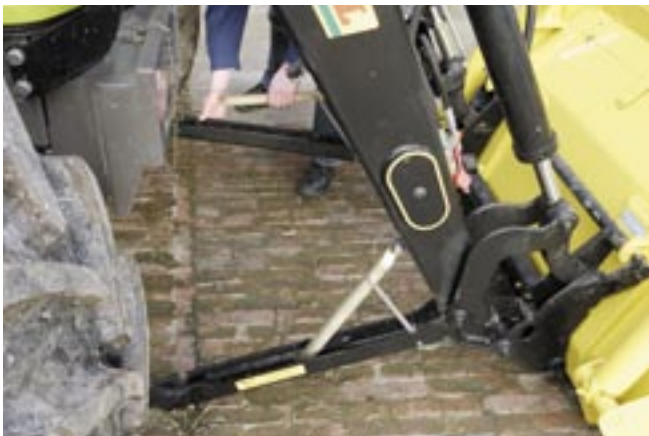
Wenn man weiß, wie die Abstellstützen aus ihrer Parkposition befreit werden, ist ihre Handhabung dank feinem Raster und Federentlastung sehr einfach.
