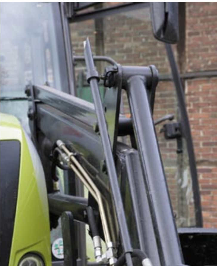
Die Verstellung der Neigungsanzeige erfordert nicht nur Werkzeug, sondern ist darüber hinaus viel zu umständlich zu verstellen.
