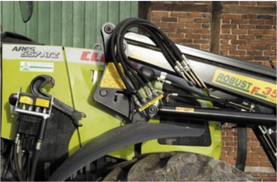
Beim Einfahren in den schmalen Frontlader muss man mit breiten Schlepperhauben aufpassen. Hilfreich ist die Auffahrrampe. Die Konsolenverriegelung bei Stoll erfolgt nach wie vor mit einem Keil, der per Hebel umgelegt wird. Hin und wieder kommt es hier beim Laderabbau zu Verspannungen, so dass der Keil sich nicht lösen lässt (laut Stoll hilft regelmäßiges Einfetten). Außerdem kann man sich beim Umlegen des Hebels die Finger an der Multikupplung stoßen. Fotos: Tovornik
