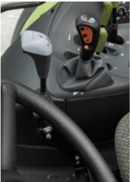
Der „EHS“- Joystick mit Tastern auf der Vorderseite ist griffgünstig in gerader Flucht vor der rechten Armlehne verstellbar montiert. Alle Funktionen sind gut mischbar, aber nicht so feinfühlig zu dosieren – und der Hebel kann bei der Arbeit das Lenkrad berühren.
