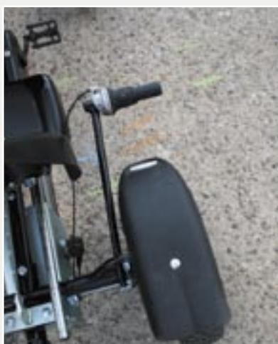
An dem Handgriff werden die sieben Gänge geschaltet sowie die Handbremse betätigt.
