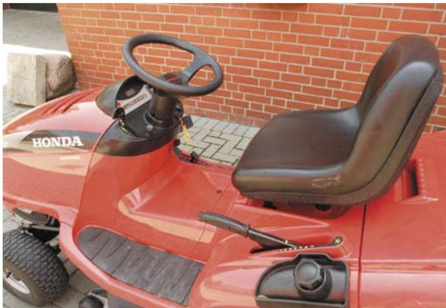
*Inbesondere beim Absteigen stört der Hebel für die Mähwerkausehebung, mit dem unfreiwillig auch schon mal eine Hose in Fetzen aufgeht. Der Tankeinfüllstutzen ist gut erreichbar.*
