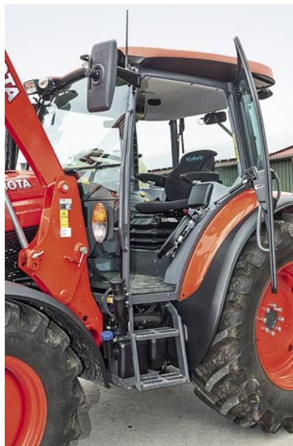
Der Aufstieg ist geräumig und vor Verschmutzung geschützt. Diesel- und AdBlue-Tank fassen nur 105 bzw. 12 l – (zu) wenig!
