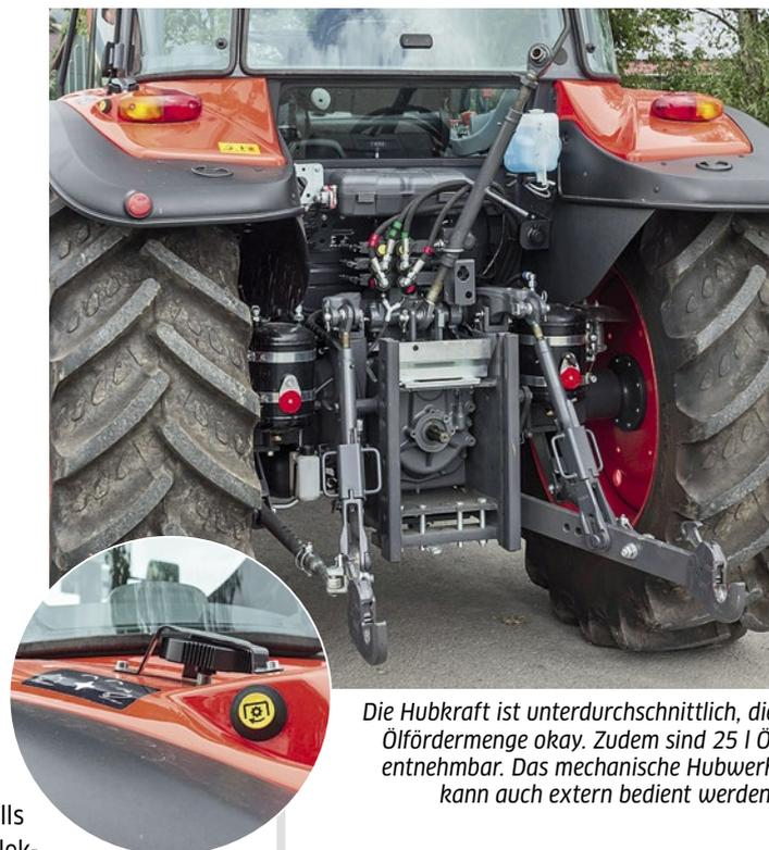
Die Hubkraft ist unterdurchschnittlich, die Ölfördermenge okay. Zudem sind 25 l Öl entnehmbar. Das mechanische Hubwerk kann auch extern bedient werden.
