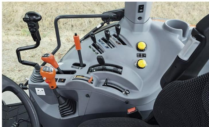
Ganghebel, Gruppenhebel und Parksperrhebel dominieren die rechte Konsole. Das Hubwerk wird mechanisch bedient, der gewaltige Frontladerhebel lässt sich besser bedienen als man zunächst denkt.
