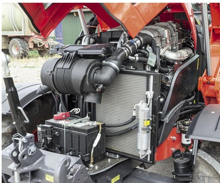
Der Vierzylinder von Kubota erfüllt die Abgasstufe IV und hat eine ordentliche Charakteristik. Er braucht aber etwas mehr Diesel als der Durchschnitt, vermutlich weil er mit bis zu 2 600 Touren dreht.
