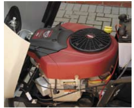
Der laut Hersteller 20 PS starke „Intek V-Twin“ zählt nach eigenen Angaben zur gehobenen Motorenklasse aus dem Hause Briggs & Stratton. Nicht zu bestreiten ist sein „gehobener“ Durst.
