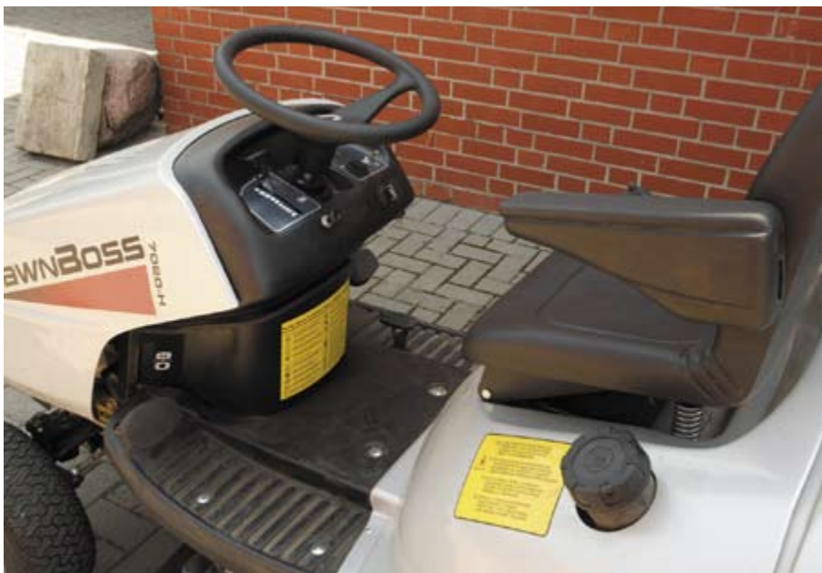
Das Armaturenbrett ist übersichtlich gestaltet und kann mit einem Tempomaten aufwarten. Die Sicht bei Kurvenfahrten ist allerdings durch die breite Haube eingeschränkt.
