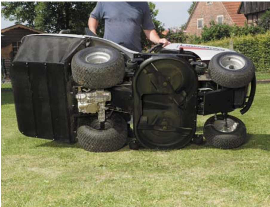
Entgegen dem Prospekt lieferte uns der Händler ein Mähdeck mit zwei Messern anstatt des Triplex-Mähwerks mit drei Messern je Rotor.
