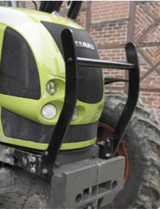
*Der weit nach vorne und oben reichende Rahmen bietet einen guten Anfahrerschutz. Zum Öffnen der Claas-Haube muss der Schutz allerdings beidseitig entriegelt und nach unten geschwenkt werden.*
