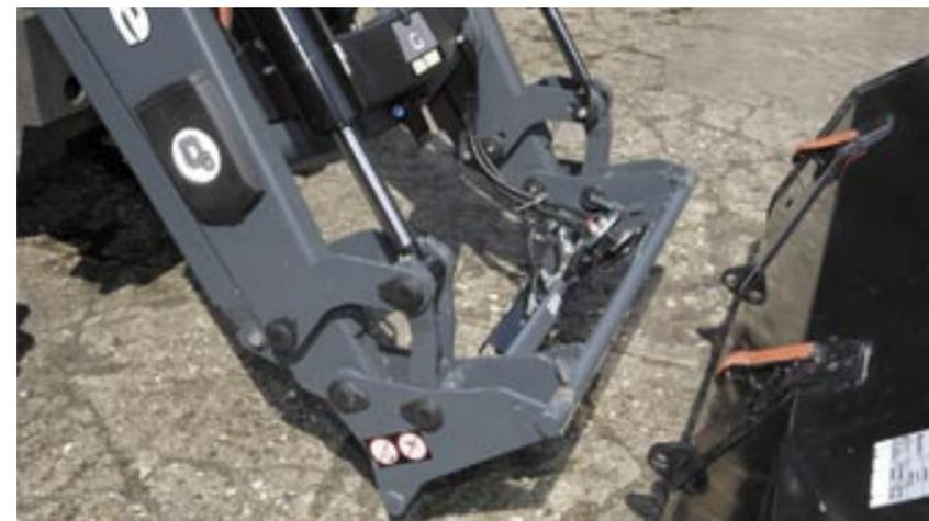
Das Werkzeug koppelt man am besten – anders als hier gezeigt – mit dem komplett ausgekippten, sehr stabilen Werkzeugträger. Dann hat man die Koppelpunkte unterhalb der Schwingenholme gut im Blick. Der Hebel für die Multikupplung „Selecto Fix“ des dritten Ölkreises (Wunschausstattung für 400 Euro) darf allerdings nicht offen stehen bleiben, sonst wird er beschädigt.
