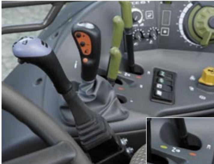
Die Schalter für die Schwingungsdämpfung (inzwischen auf dem Joystick platziert) und die Freigabe der hydraulischen Geräteverriegelung hatte Alö schön in die Claas-Instrumentenkonsole integriert.
