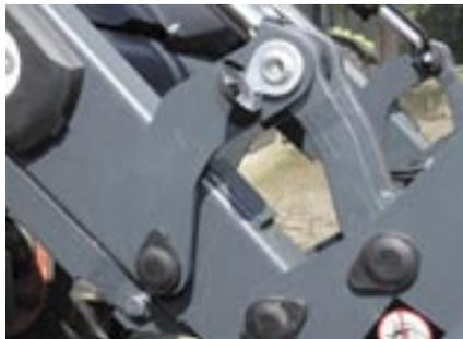
*Bei der Quicke-Schwinge schützt Alö die Schmiernippel in den Bolzen serienmäßig mit Abdeckkappen aus Kunststoff.*
