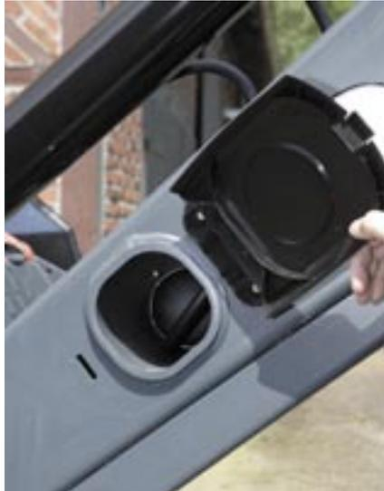
*Die beiden Stickstoffblasen für die Schwingungsdämpfung sind geschützt im Querrohr montiert. Wie lange die Kunststoffklappe auf jeder Seite (die rechte Seite kann man als Werkzeugbox nutzen) den harten Praxiseinsatz überdauert, können wir nicht sagen.*
