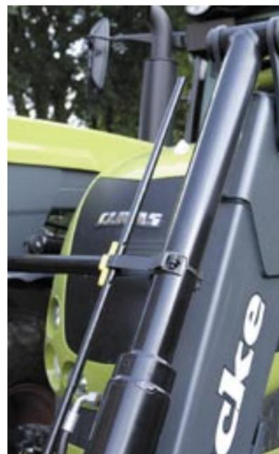
Die dreistufige und werkzeuglos verstellbare Anzeige für die Werkzeugneigung hat uns gut gefallen.
