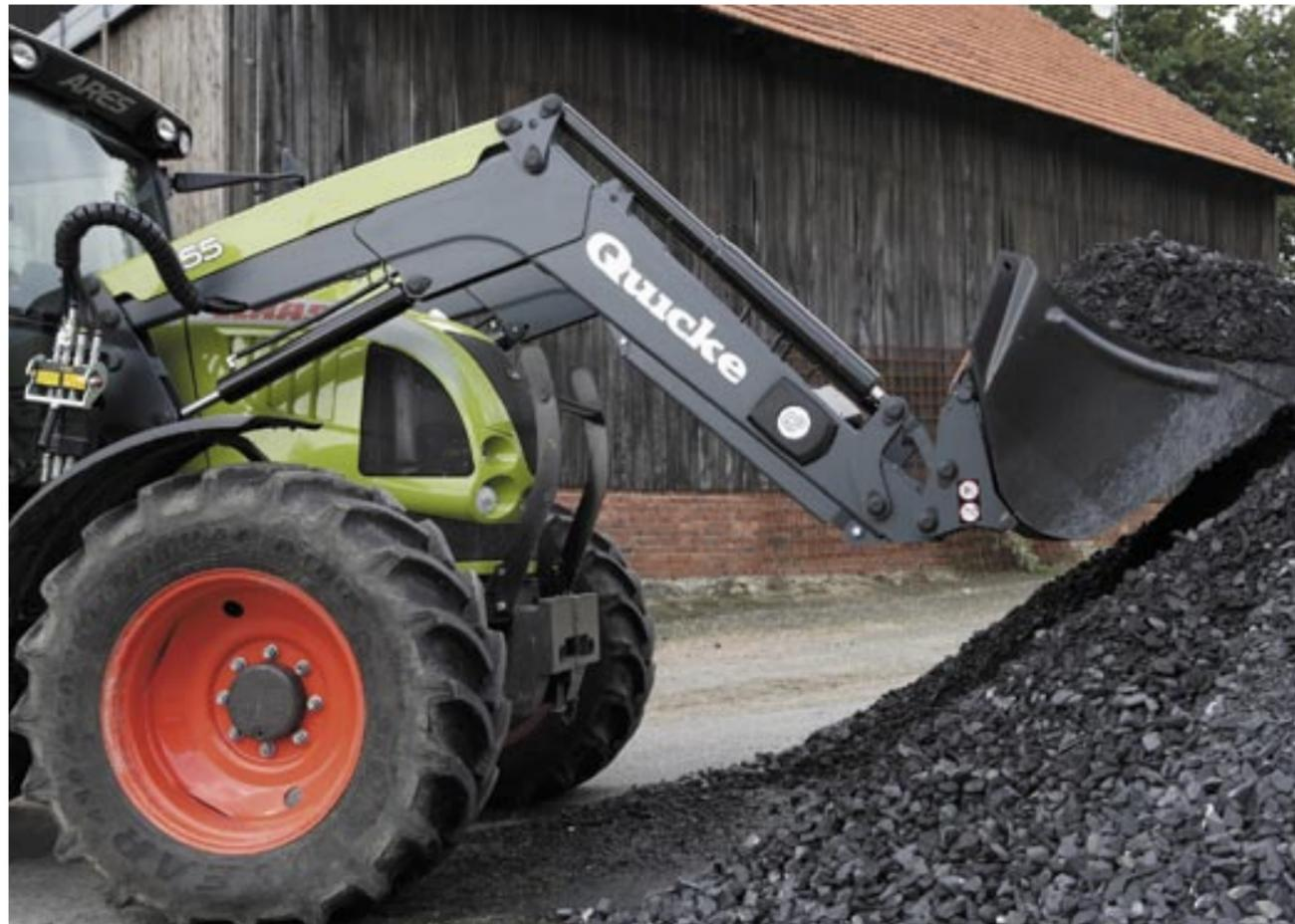
Der An- und Abbau des Quicke-Laders klappt dank halbautomatischer Verriegelung „Lock & Go“ auch ohne Einfahrhilfe prima. Aufpassen muss man nur, dass man mit den Schlepperkotflügeln nicht schon die Verriegelung aktiviert.
