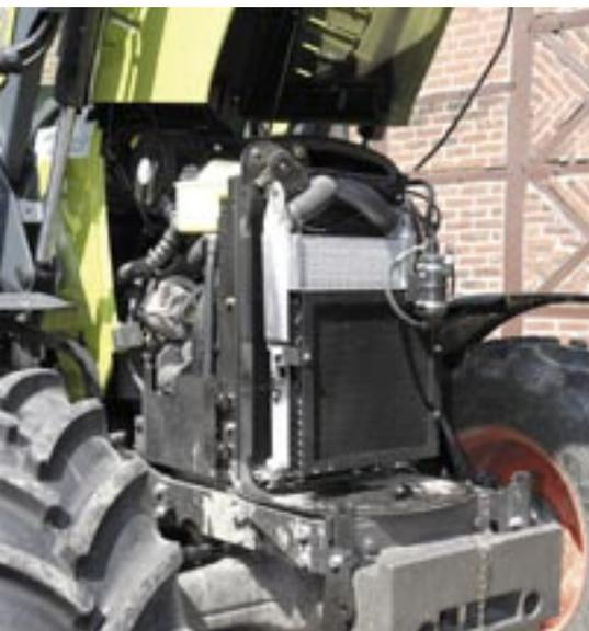
*Alle Wartungsstellen am Claas Ares 557 waren bei angebaute Schwinge gut erreichbar. Der Luftfilter lässt sich bei ganz angehobener Schwinge entnehmen.*
