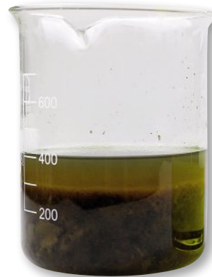
Die weit vorangeschrittene Dieselpest zeigt sich durch die dunkle Verfärbung und den Schlamm am Boden.
