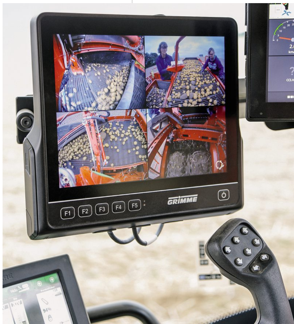
Die Prozessüberwachung mit mehreren Kameras erfordert einen größeren Monitor mit guter Auflösung.
