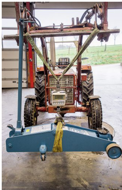
Der Jumbo Jack wiegt mit knapp 130 kg rund 30 kg weniger als auf dem Typenschild angegeben. Schwergewicht ist das Compac-Gerät mit rund 180 kg. Fotos: Bertling
