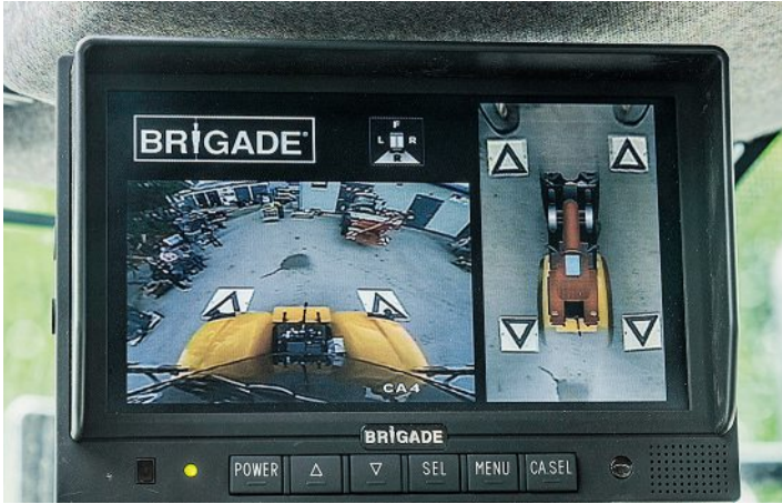
Der Monitor sollte in der Kabine nahe einer für den Fahrer günstigen Sichtachse angebracht werden. Fotos: Tovornik, Werkbild
