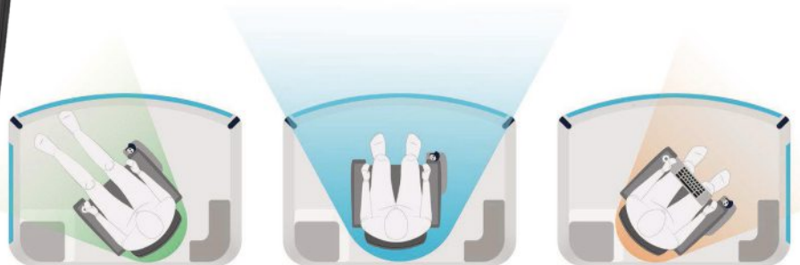
Links gedreht ist der Fahrer im Entspannungs-Modus, mittig im Arbeits-Modus und nach rechts gedreht im Büro-Modus.
