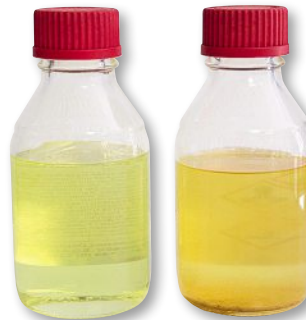
Hier ist die Alterung des Diesels bereits durch feste Bestandteile und die trübe Färbung in der Flasche rechts zu erkennen.
