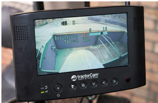
Typischer Einsatz für eine Funkkamera. Es besteht eine Sichtverbindung zwischen Sender und Empfänger. Das Signal ist gut. Fotos: Tovornik
