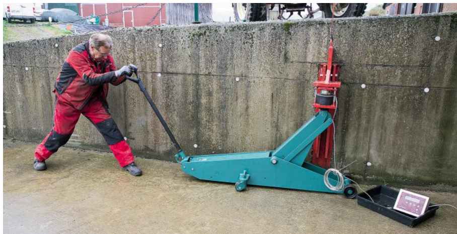
Mit einer Wiegezelle haben wir die maximalen Hubkräfte sowie den Hubkraftverlust in einer Stunde ermittelt. Der Wagenheber von Compac blieb in puncto Kraft unter den Werksangaben.
