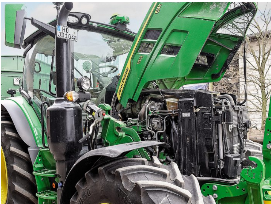
Moderne Anlagen zur Abgasnachbehandlung werden wieder kompakter. Je nach Strategie des Herstellers finden einige Bauteile auch unter der Haube Platz. Foto: Tastowe
