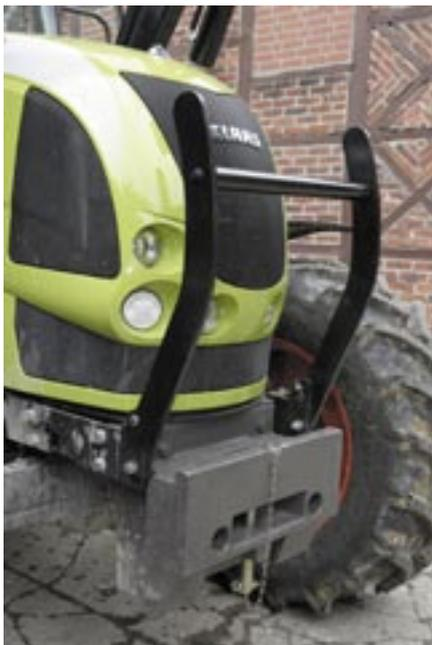
*Der weit nach vorne und oben reichende Rahmen bietet einen guten Anfahrerschutz. Zum Öffnen der Claas-Haube muss der Schutz allerdings beidseitig entriegelt und nach unten geschwenkt werden.*
