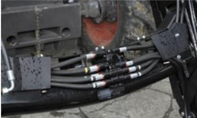
*Soweit möglich sind alle Leitungen geschützt im Schwingenholm untergebracht und münden in dem zentralen Verteilventil „Compact Valve“, das auf dem Querholm unter einer Abdeckung (hier demontiert) geschützt untergebracht ist.*
