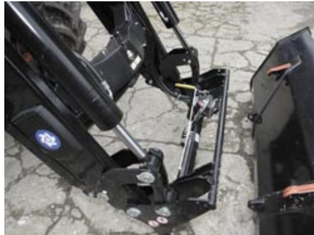
Das Werkzeug koppelt man am besten – anders als hier gezeigt – mit dem komplett ausgekippten, sehr stabilen Werkzeugträger. Dann hat man die Koppel­punkte unterhalb der Schwingenholme gut im Blick. Der Hebel für die Multikupplung „Selecto Fix“ des dritten Ölkreis­es (Wunschausstattung für 400 Euro) darf allerdings nicht offen stehen bleiben, sonst wird er beschädigt.
