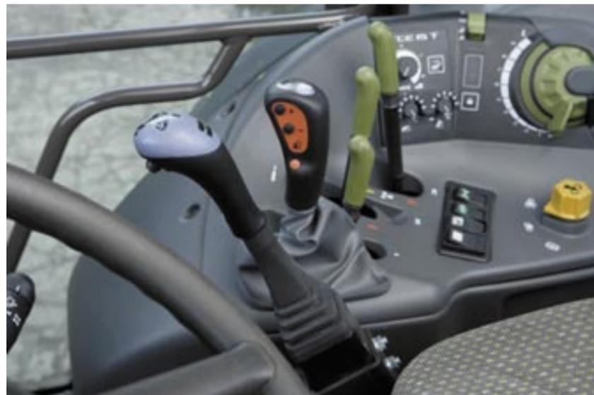
In direkter Flucht zur rechten Armlehne war der „ErgoDrive“-Joystick gut erreichbar mit einem stabilen und verstellbaren Gestänge montiert. Beide Drucktaster für Zusatzfunktionen vorne am Hebel sind gut bedienbar. Bei annehmbaren Hebelwegen sind alle Funktionen gut dosier- und mischbar, der Hebel kann aber mit dem Lenkrad kollidieren.
