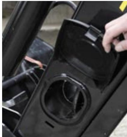
*Die beiden Stickstoffblasen für die Schwingungsdämpfung sind geschützt im Querrohr montiert. Wie lange die Kunststoffklappe auf jeder Seite (die rechte Seite kann man als Werkzeugbox nutzen) den harten Praxiseinsatz überdauert, können wir nicht sagen.*
