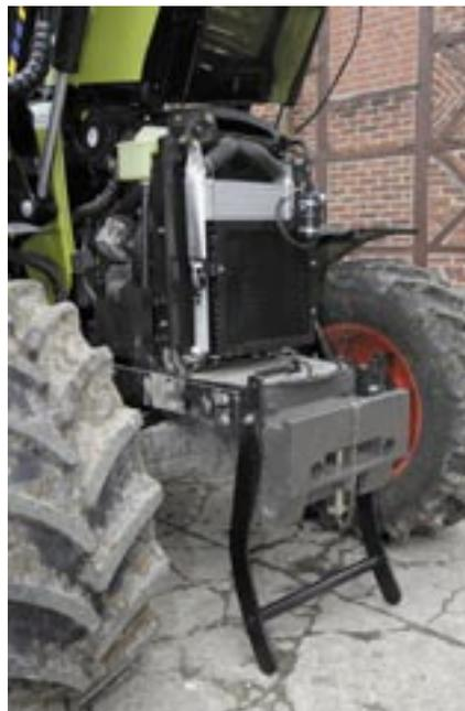
*Alle Wartungsstellen am Claas Ares 557 waren bei angebauter Schwinde gut erreichbar. Der Luftfilter lässt sich bei ganz angehobener Schwinde entnehmen.*
