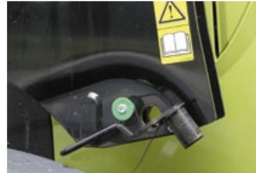
Das Einfahren in den Trima-Frontlader ist dank der Baubreite der Schwinde kein Problem. Die Konsolenverriegelung erfolgt allerdings manuell per Bolzen, der wegen fehlender konischer Spitze und passgenauen Bohrungen nicht immer einfach zu stecken war. Fotos: Tovornik
