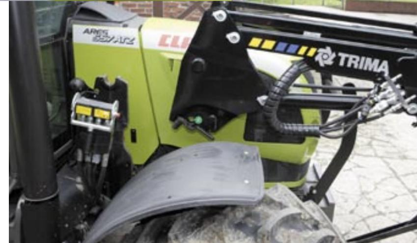
sprechend anpassen und vor allem auf schlechteren Wegstrecken langsam fahren. Allerdings verträgt die Vorderachse des Ares 557 laut Claas statische Belastungen bis zu 19 t bei Geschwindigkeiten unterhalb von 7 km/h.
