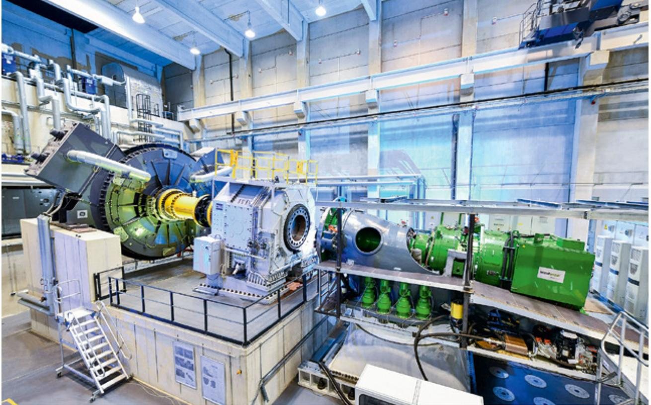
△ Die maxcap-Anlage auf dem Prüfstand des Center for Wind Power Drives (CWD) an der RWTH Aachen.
