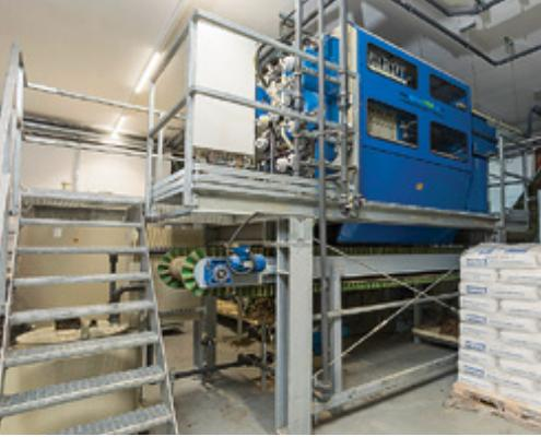
◁ Nach dem Neutralisieren mit Kalk und Natronlauge fällt das Phosphatsalz aus der Flüssigkeit aus.
