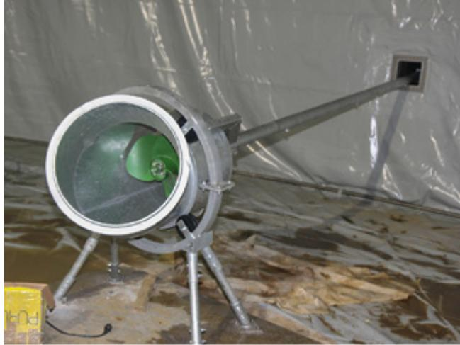
◁ Der Propeller des Rührwerks steckt in einer schwenkbaren Düse.
