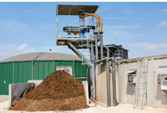
◁ Ein Sepcom-Pressschneckenseparator: Mit dem Mikrofilter wird die darin erzeugte Flüssigphase weiter aufbereitet.
