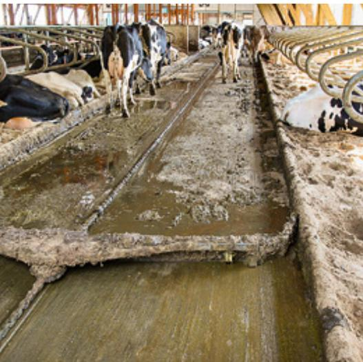
△ Bei einer Faltschieberentmischung kommt die Gülle frisch in den Fermenter.
