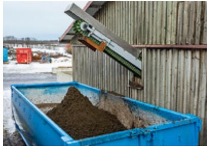
◁ △ Der Vakuumseparator trennt feine Feststoffe aus dem Gärrest, nachdem eine Schneckenpresse bereits Grobes separiert hat.
