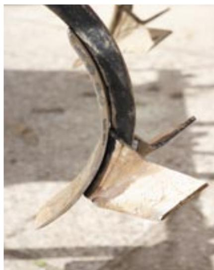
Wird tief gearbeitet, werden das Segment mit zwei Flügeln abgenommen und ein Distanzstück zwischen Zinken und Schar eingefügt. Es gibt elegantere Lösungen, wenigstens sind die Schrauben immer gängig, weil sie im „Schatten“ des Scharns sitzen.
