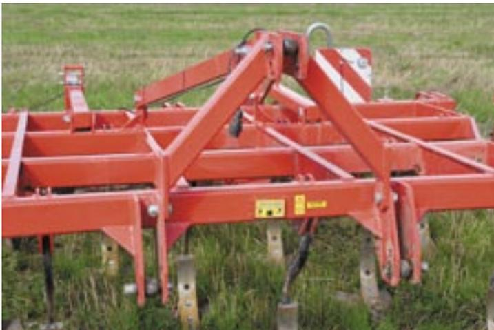
Der Anbaubock ist auf die Kat. II ausgelegt. Zwei Koppelhöhen und zwei Oberlenkerbohrungen stehen zur Verfügung, davon eine mit Langloch. Die Kabelverlegung war noch okay, eine dauerhafte Haltbarkeit bezweifeln wir.
