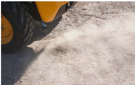
Egal wo er rumfährt, der JCB-Lader wirbelt mit seinem nach unten gekröpften Auspuff-Endrohr unnötig viel Staub auf.
