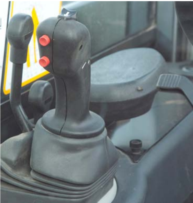
Der obere Taster vorne am Joystick betätigt die Hupe, der untere ist frei. Oben auf dem Hebel sitzt der Schiebeschalter für die Wendeschaltung.
