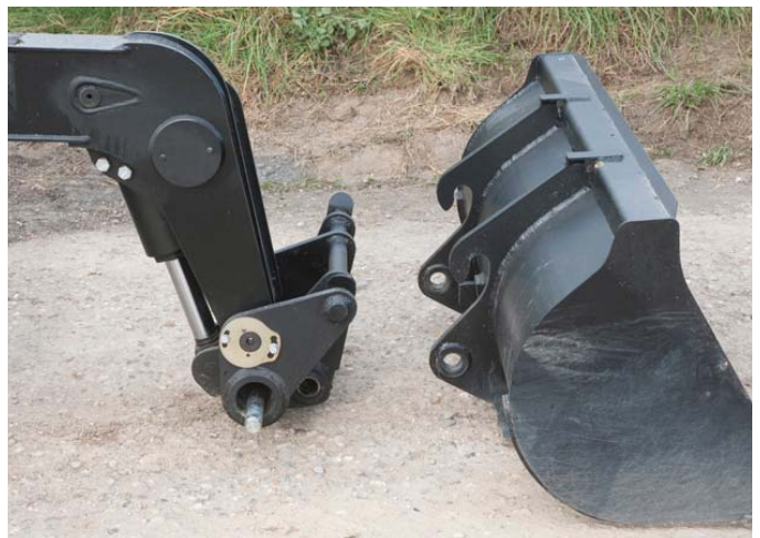
Zum Koppeln lässt sich das Werkzeug mit dem Schnellwechselrahmen gut fangen, verriegelt werden muss allerdings manuell mit einer durchgehenden Stange auf der linken Seite. Die Arretierung der Verriegelung sollte besser auch auf der linken statt auf der rechten Seite erfolgen.
