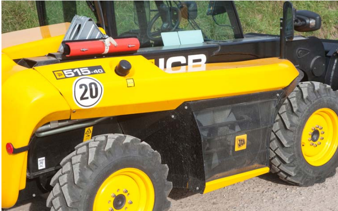
Motor- und Ölkühler sind zusammen mit dem Hydrauliköltank auf der rechten Maschinenseite unter einer umständlich verschraubten Haube platziert.
