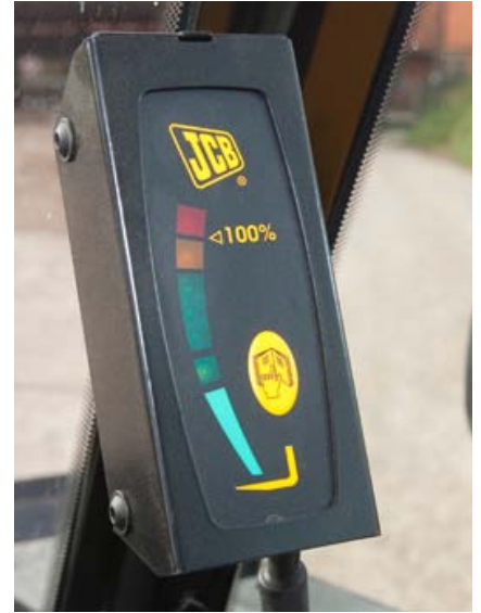
Die Lastanzeige befindet sich in einer extra Konsole am rechten A-Holm der Kabine.
