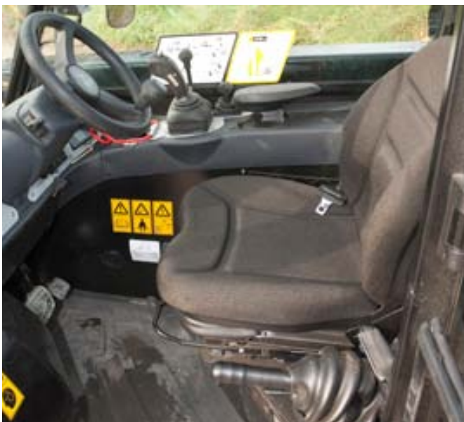
Der mechanisch gefederte Sitz ist mit Stoff bezogen – nicht abwaschbar aber bequem. Das gut positionierte Lenkrad lässt sich nicht verstellen.
