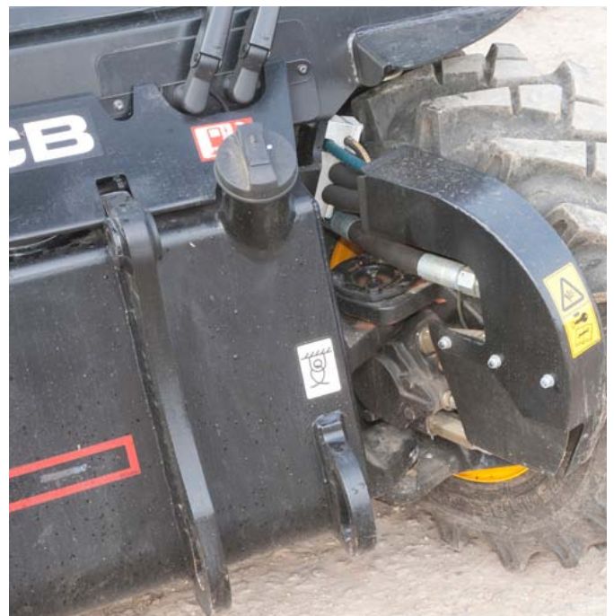
Die Schmiernippel der Achsschenkel sind wegen der Radmotoren weniger gut erreichbar. Zwischen den Vorderrädern ist der Dieseltank bequem zugänglich.
