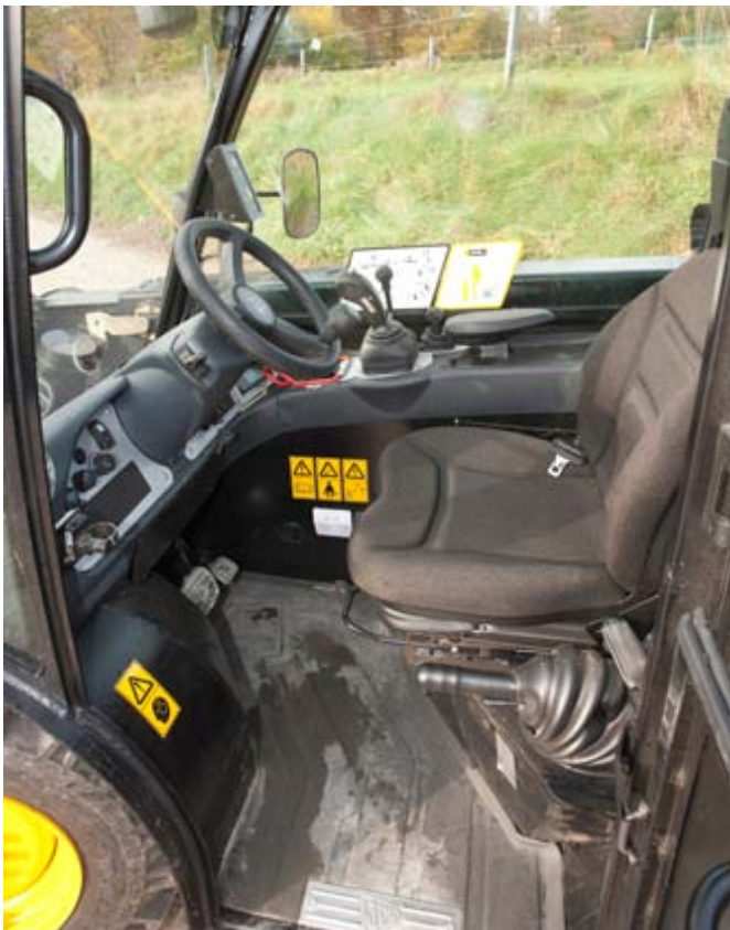
Die niedrig angeordnete Kabine bietet einen einfachen Einstieg, der allerdings in der Breite durch den Kotflügel eingeschränkt wird.
