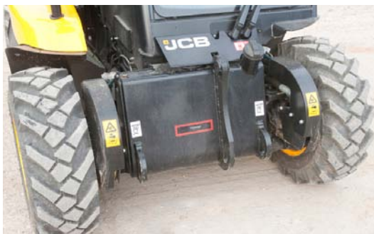
Das unverwechselbare Kennzeichen des 515-40 ist sein Fahrtrieb mit je einem Ölmotor an jedem Rad, der sich im Praxistest als nicht gerade leichtläufig präsentierte.
