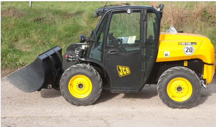
Beim modern gestylten JCB 515-40 ist der Teleskoparm auf der rechten Maschinenseite angelenkt. Der Motor arbeitet im Heck der Maschine, der Fahrer sitzt in der Kabine kurz hinter der Vorderachse.
