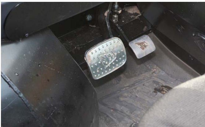
Gas- und kombiniertes Inch-/Bremspedal sind gut positioniert und lassen sich gut bedienen. Nur der massive Kotflügel schränkt die Beinfreiheit ein.
