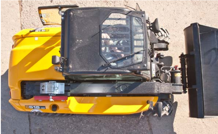
Das Schutzgitter sitzt leider unterhalb der Scheibe.
