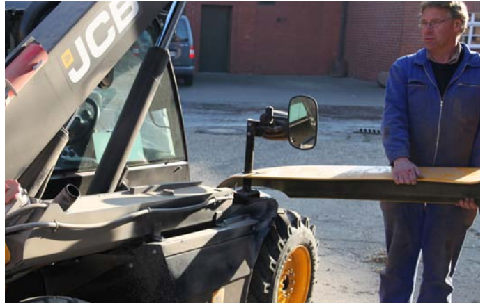
Motor- und Ölkühler sind zusammen mit dem Hydrauliköltank auf der rechten Maschinenseite unter einer umständlich verschraubten Haube platziert.
