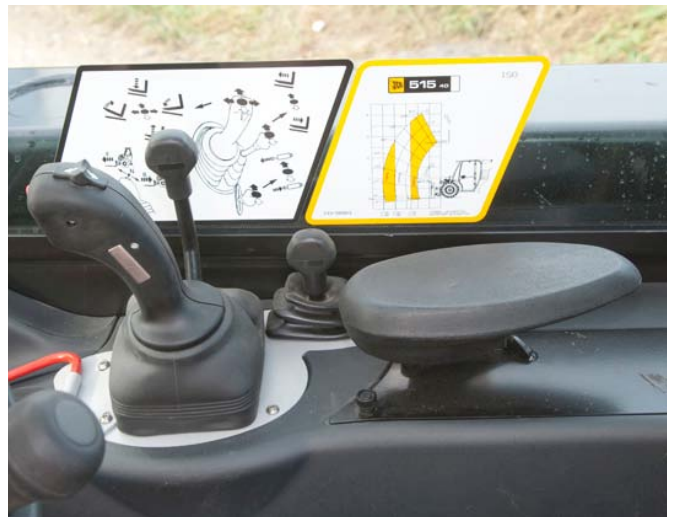
Die gepolsterte Armlehne auf der rechten Konsole ist zur Bedienung des Joystick sehr komfortabel. Für den Teleskopausschub und die vierte Funktion müssen allerdings zwei separate Hebel betätigt werden.
