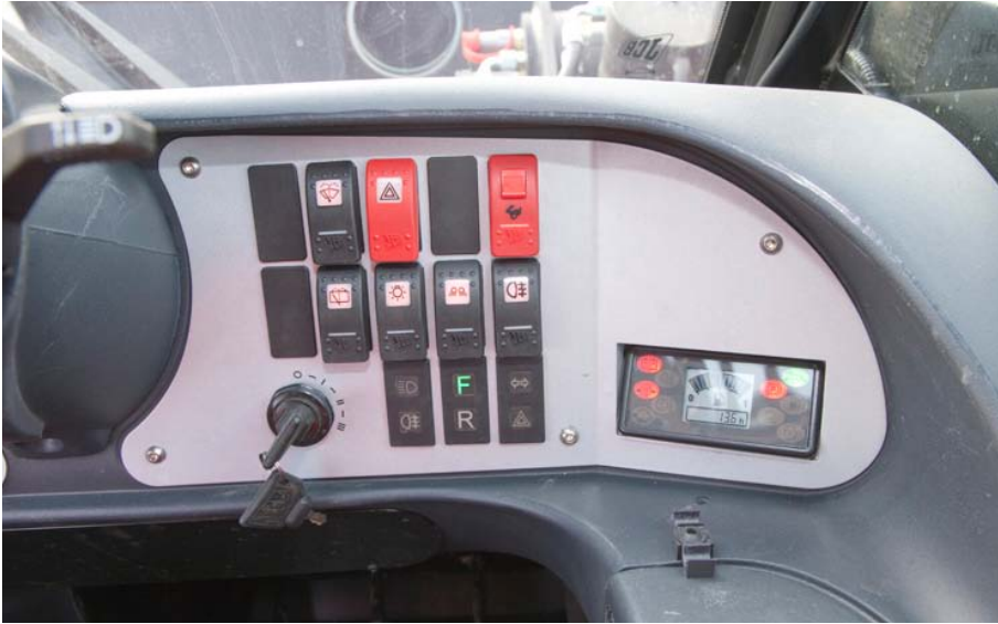
Die Instrumentierung besteht lediglich aus einigen Warnleuchten sowie kleinen Digitalanzeigen für den Tankinhalt und die Betriebsstunden. Sehr schön: Die Schalter sind immer unterleuchtet.
