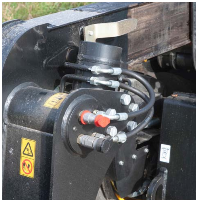
Die beiden flach dichtenden Ölkupplungen sitzen leider fix am Telearm, so dass die Schläuche zum hydraulischen Werkzeug lang genug sein müssen. Einen zusätzlichen drucklosen Rücklauf gibt es nicht.
