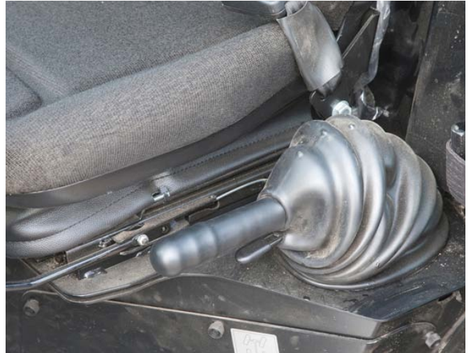
Wirkungsvoll und verstellbar: der Handbremshebel links neben dem Fahrersitz. Nicht aktiviert kann der Hebel allerdings beim Ein- und Aussteigen stören.
