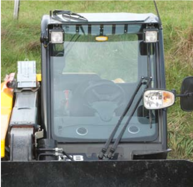
Das Wischfeld des Frontscheibenwischers ist in Ordnung. Für das Dach- und Heckfenster gibt es ebenfalls einen Scheibenwischer.
