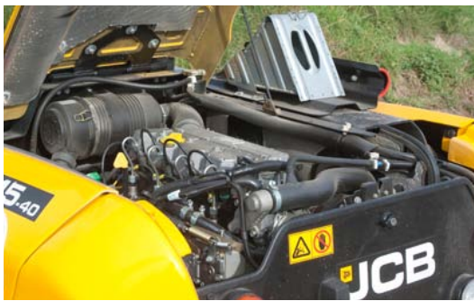
JCB setzt auf einen Turbomotor mit vier Zylindern und 37,5 kW/51 PS von Kohler.
