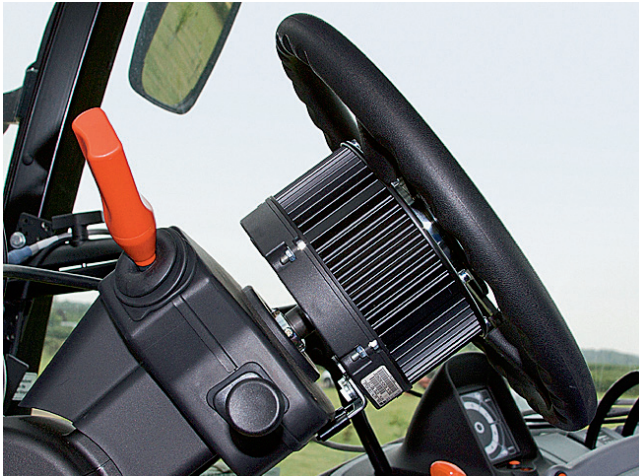
Das Lenkrad von Topcon hat seinen Elektroantrieb in einer großen Nabe integriert. Zur Montage braucht man eine tiefe 24-mm-Langnuss.
